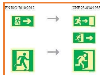
Figura 1. Señalética de salidas de emergencia
