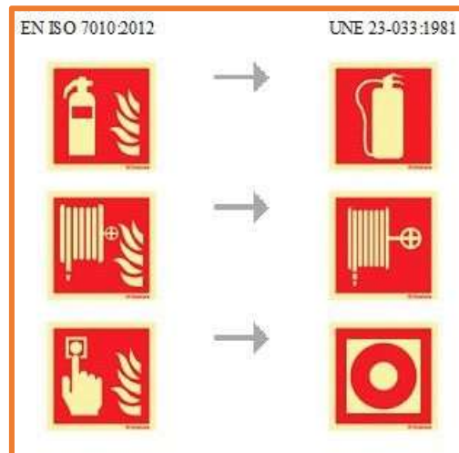
Figura 6. Señalética de los equipos de protección contra incendios
