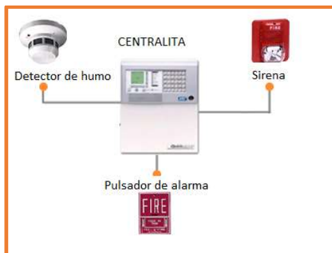
Figura 7. Ejemplo de centralita, sirena, detector de humo y pulsador de alarma
