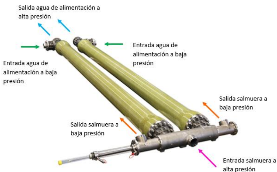
Figura 22. CIP de desplazamiento positivo DWEER (Flowserve)
