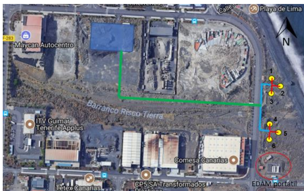
Figura 31. Ubicación de los pozos de captación y representación de las redes de tuberías de alimentación de la EDAM del Valle de Güímar
