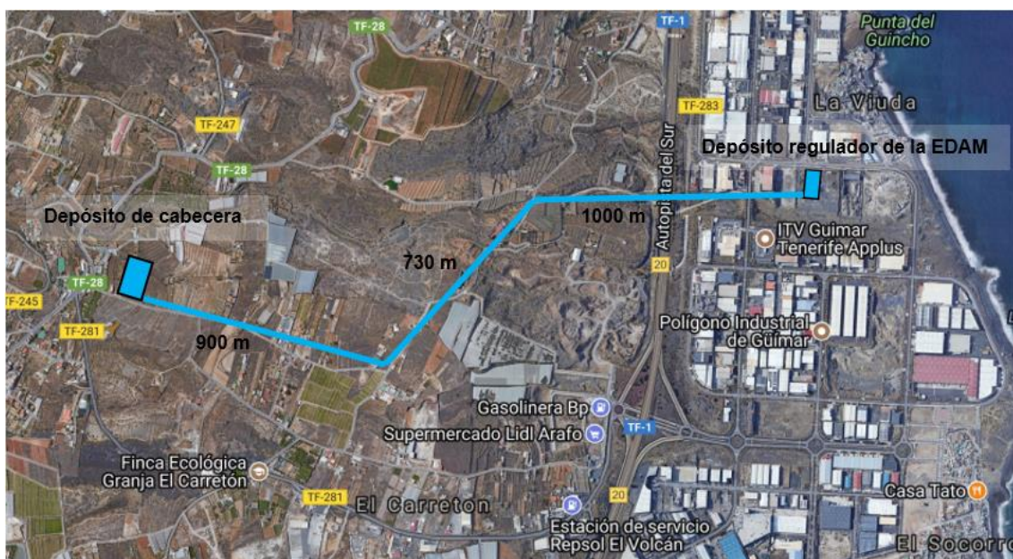
Figura 40. Recorrido de la tubería de distribución
