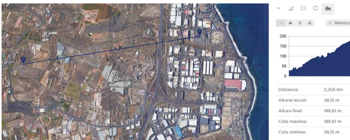
Figura 41. Elevación del terreno entre los depósitos regulador y de cabecera (Goolzoom)
