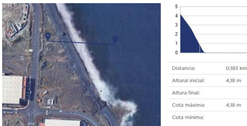
Figura 32. Elevación máxima del terreno donde se van a construir los pozos de captación (Goolzoom)
