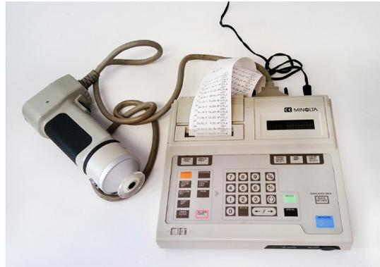
Imagen 3.15: Calabacines antes de entrar en la cámara frigorífica (izquierda) y colorímetro utilizado para evaluar la variación de color de la epidermis de los frutos (derecha).
