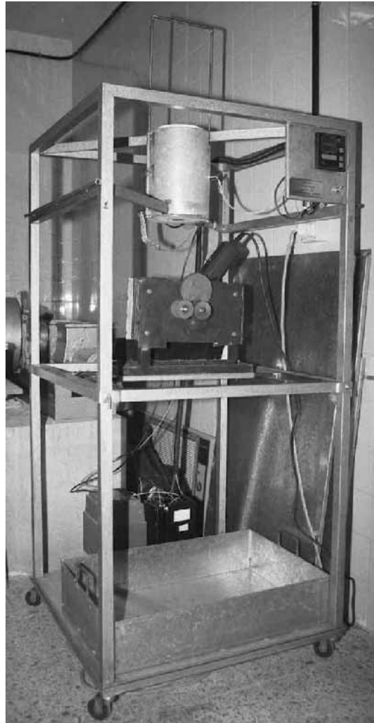
Figura 17a. Estructura completa del horno empleado en la obtención de las fibras.
