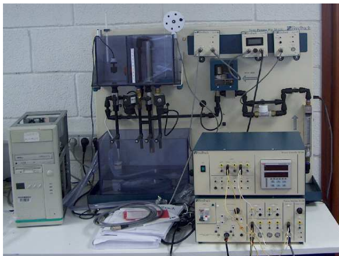
Figura 5.44.: Fotografía de la Planta de Control de Nivel de Agua en un Depósito.
