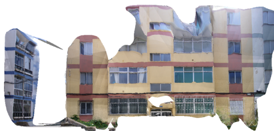
Figura 13: Fotogrametría realizada con Autodesk Recap. Fuente: elaboración propia.
