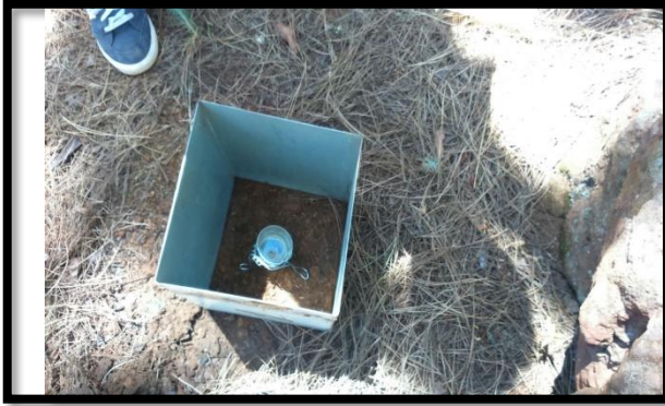
Trampa de NaOH para el muestreo de CO 2 emitido por el suelo en el pinar de Las Raíces.
