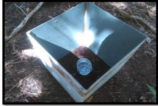
Trampa de NaOH para el muestreo de CO 2 emitido por el suelo en el Monteverde de Anaga.
