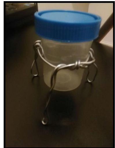
Figura 4: Trípode con el recipiente en el que se disponen los 50 ml de NaOH.
