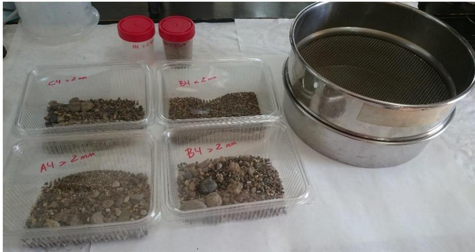
**Figura 4.** Tamiz de 2 mm y las distintas muestras separadas en función del tamaño.
