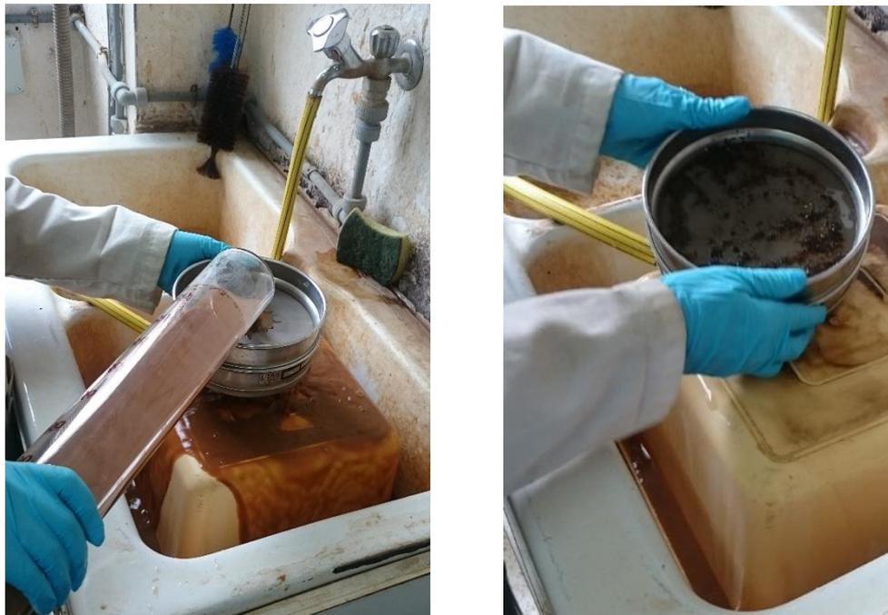
**Figura 8.** Filtrado y lavado de cada muestra dispuesta en las probetas de 1 litro.
