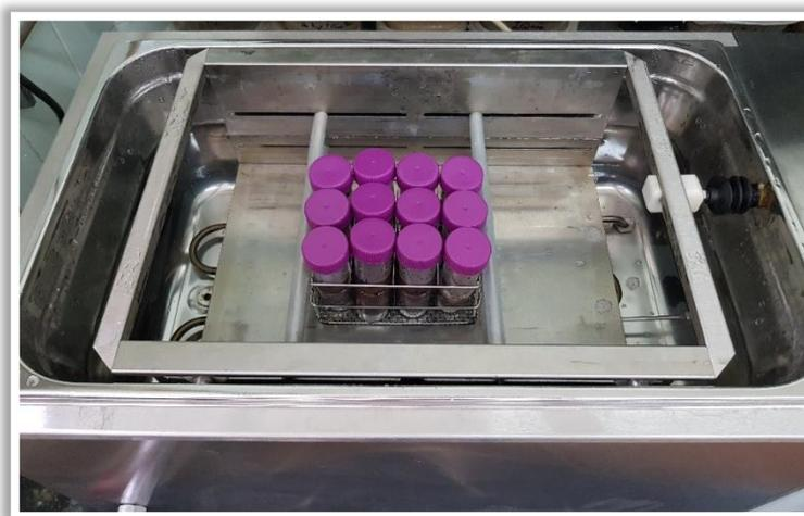
Figura 4: Muestras de suelo en el baño de agitación termostatado para su incubación.
