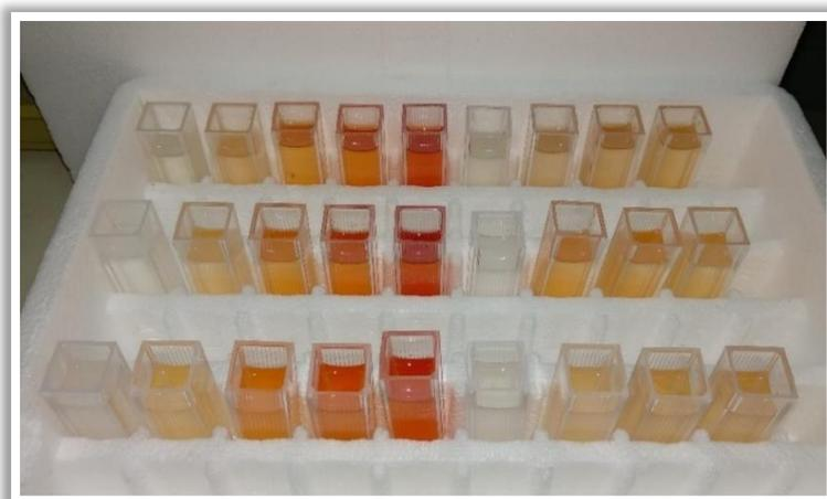
Figura 5: Muestras analizadas en el espectrofotómetro. A la izquierda se observan las muestras que forman parte de la recta patrón; a la derecha las tres réplicas de cada muestra de suelo.
