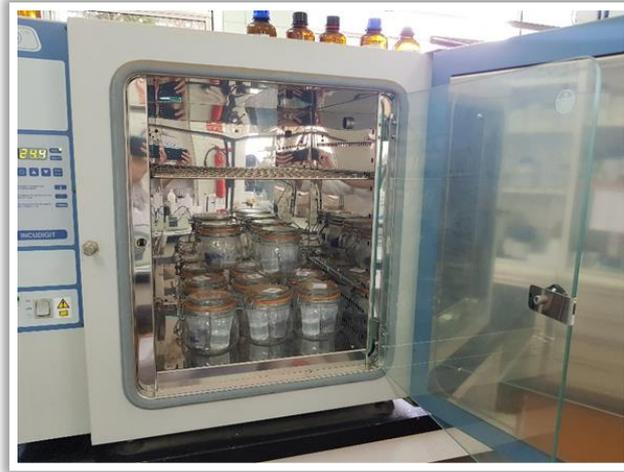
Figura 3: Estufa utilizada en el método de respiración mediante incubación en laboratorio.
