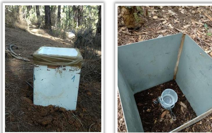
Figura 2: Cámaras de acero inoxidable utilizadas para calcular la respiración del suelo en el campo.
