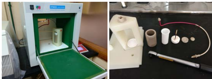
Figura 4.1.2.1: El horno microondas con sus accesorios.
