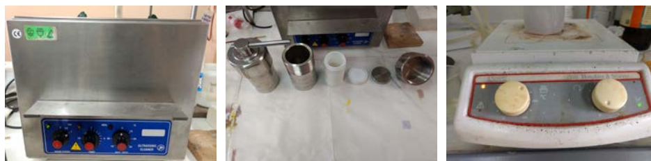
Figura 4.1.2.2: El limpiador por ultrasonidos, el reactor de acero inoxidable y el calentador agitador.
