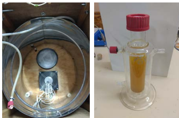
Figura 4.1.3.2: La caja de radiación y el reactor de vidrio de doble pared.
