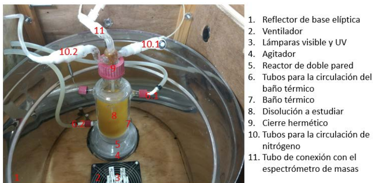
Figura 4.1.3.3: Disposición de los elementos para la fotocatalisis.
