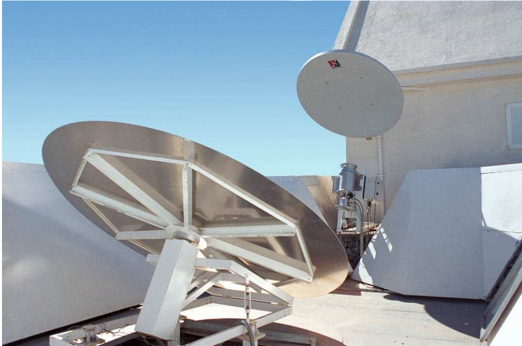
Figura 3.1: Fotografía de COSMO15 en la que se muestra el sistema óptico al completo (espejo de aluminio y parabólico) y el criostato que contiene a la antena y a la primera etapa de amplificación.
