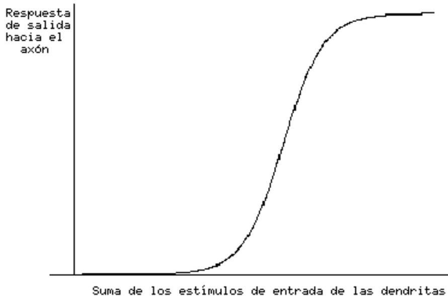
Figura 3.4: Forma de una función de transferencia neuronal. El que se trate de una función no lineal es la característica que confiere a las RN su versatilidad. Nótese que para niveles bajos de estimulación (entrada), la respuesta (salida) es despreciable.
