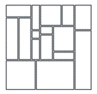
Figura 2.13. Empaquetamiento óptimo del SPP obtenido mediante UCT.
