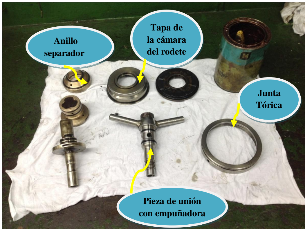
Ilustración n° 48: Piezas de la depuradora
