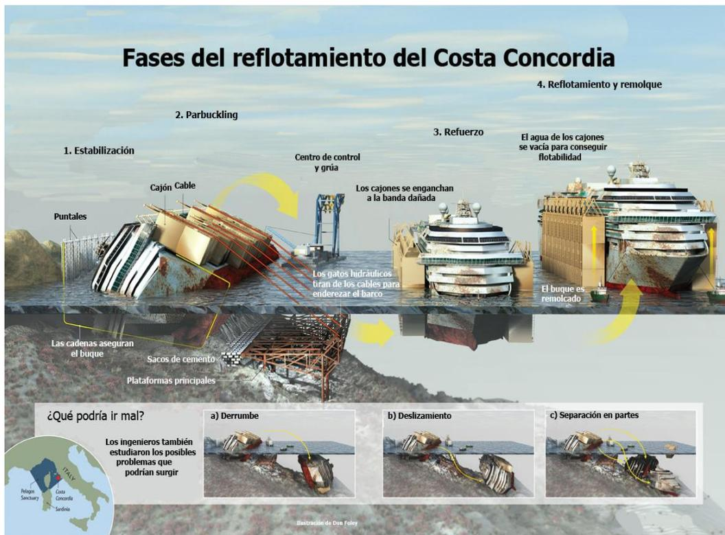
Ilustración 28: Fases de reflotamiento del Costa Concordia. Fuente: Don Foley
