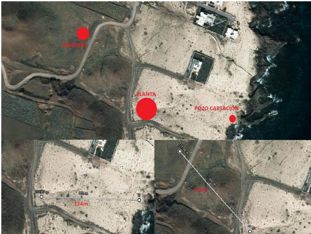
Figura 15 . Distancia de tuberías
