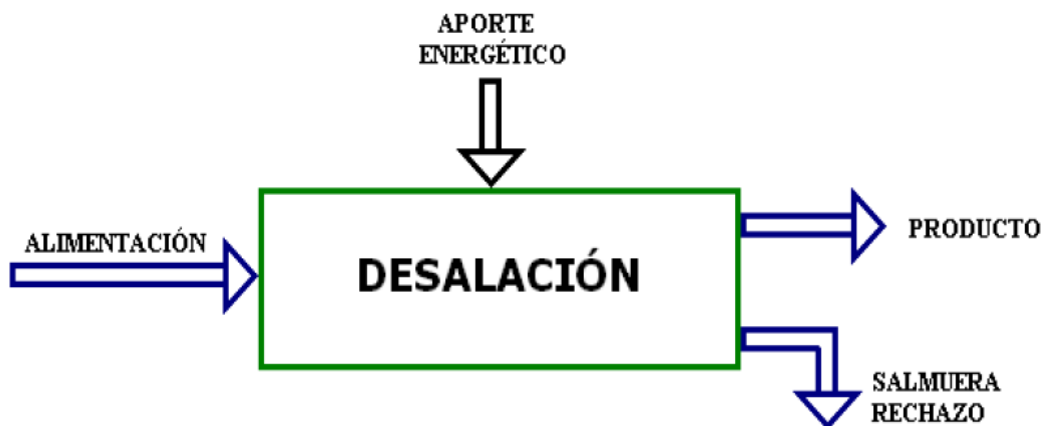
Figura 1. Esquema general del proceso de desalación. Elaboración propia.
