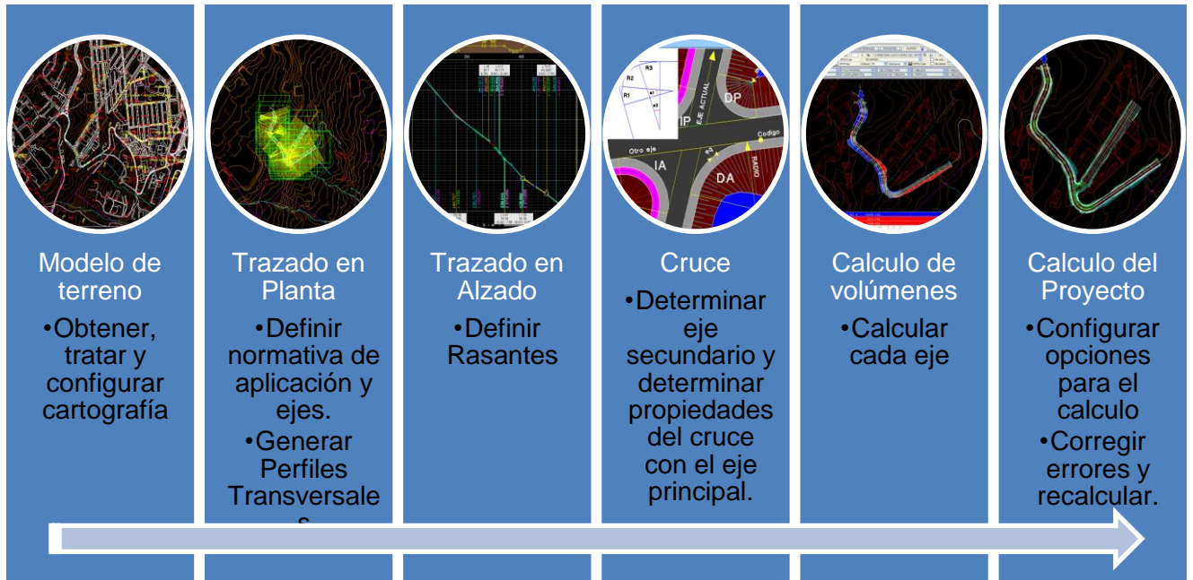
Figura 12. Esquema del proceso de Modelado CIM. Fuente: Elaboración propia
