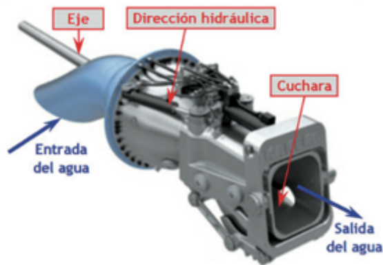
Ilustración 21: Esquema hidráulico waterjet Fuente: Informe técnico A06/2011 Ministerio de fomento [4]
