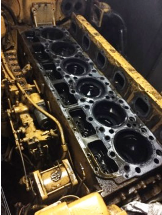
Ilustración 89: Desmontaje culata MA 2 Fuente: Trabajo de campo
