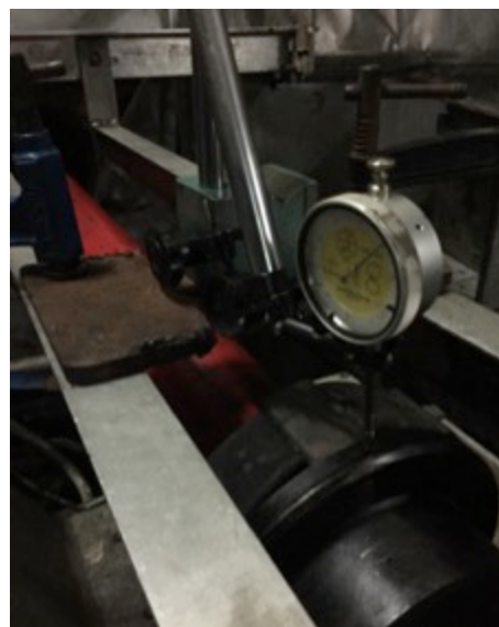
Ilustración 72: Reloj comparador sobre eje Fuente: Trabajo de campo
