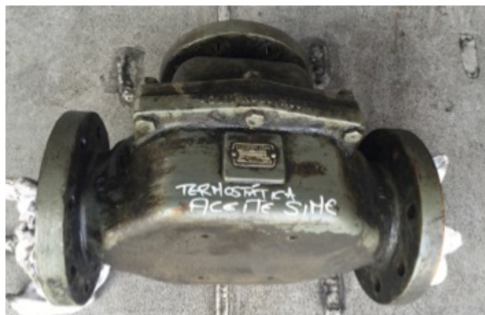
Ilustración 94: Termostática aceite SIME Fuente: Trabajo de campo
