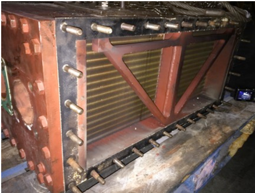
Ilustración 73: Enfriador aire de barrido Fuente: Trabajo de campo
