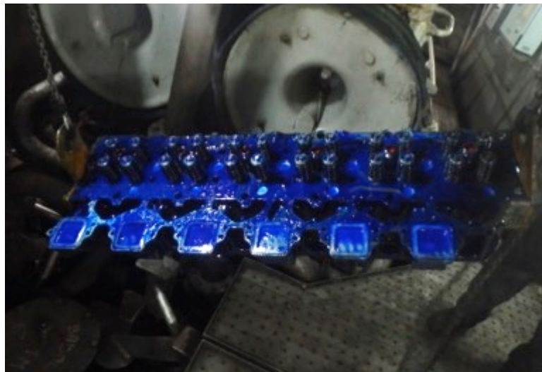
Ilustración 91: Culata reacondicionada MA2 Fuente: Trabajo de campo
