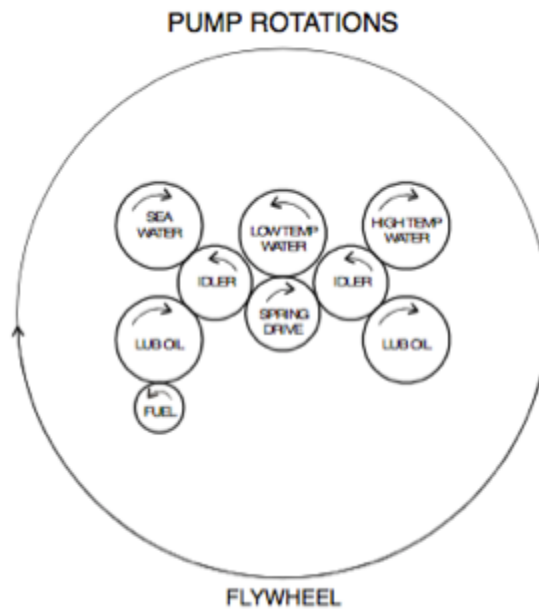
Ilustración 31: Sentido de giro bombas MMPP Fuente: Manuales del buque [2]
