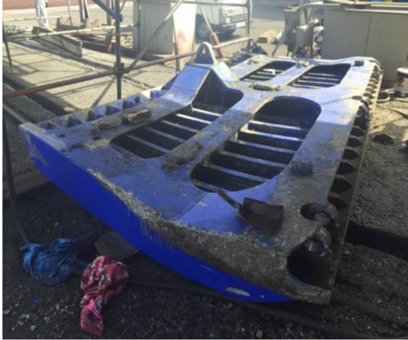
Ilustración 24: Trim-Tab Fuente: Trabajo de campo
