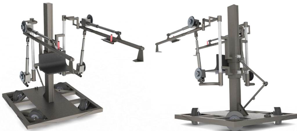
Fig. 32: Exoesqueleto a cuerpo completo con brazos en acero
