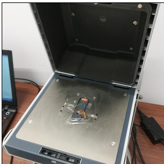
Fig. 28: Fragmento colocado en el analizador de Fluorescencia de Rayos X de Energía Dispersiva
