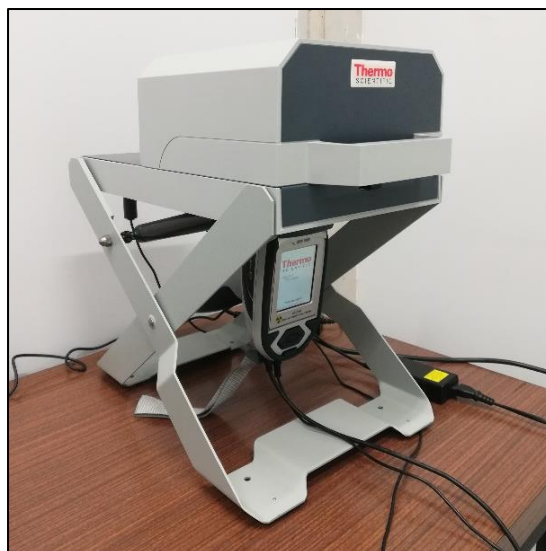
Fig. 29: Analizador cerrado herméticamente para comenzar con el análisis.
