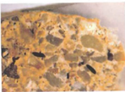
IMG 30. Imagen obtenida del MHCB que refleja un corte estratigráfico donde se puede ver con claridad la granulometría y la capa de color (Laboratorio de análisis, 2004)
