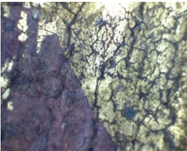
Fig. 23. Estofado a 200 aumentos. Observamos los bordes regulares del oro que forman el dibujo sobre la pintura. Podemos ver como la capa del pan de oro está craquelada.
