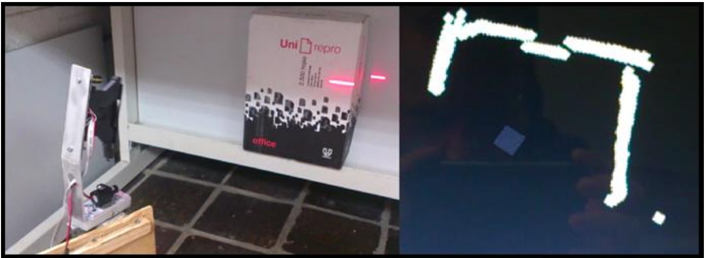
Figura 5.4. A la izquierda una foto del entorno. A la derecha el barrido láser 2D realizado en rviz.
