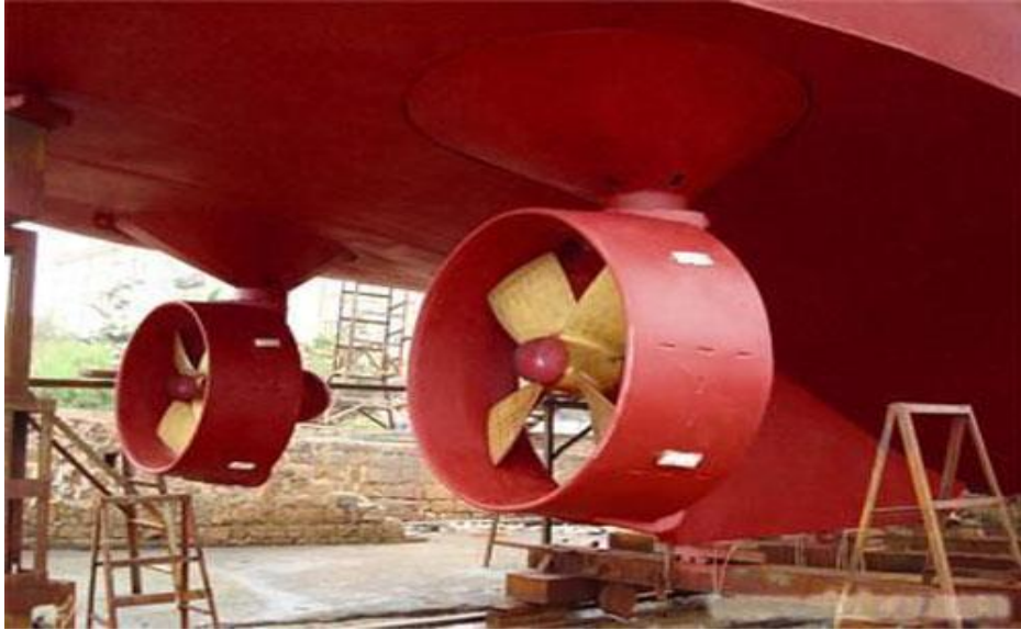
Foto 19: Popa de un remolcador ASD donde se puede apreciar el quillón extendiéndose muy hacia popa (Fuente: http://www.google.es )
