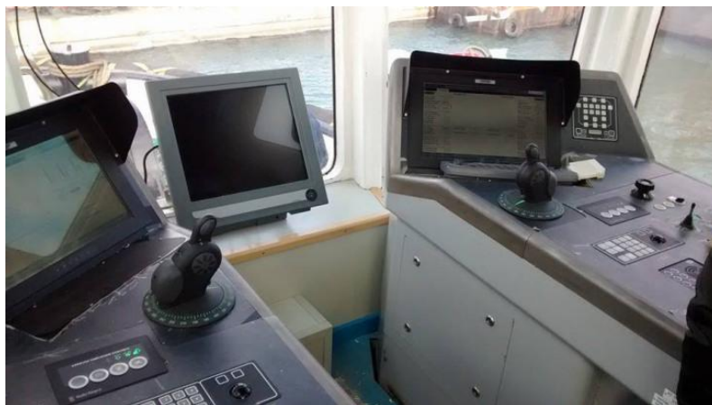
Foto 19: Puente de mando de un remolcador (Fuente: http://www.google.es )
