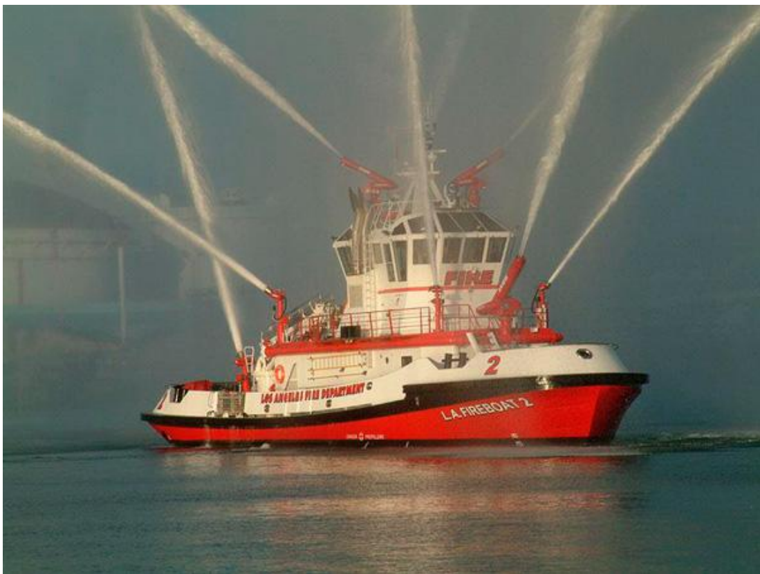
Foto 10: monitores de agua instalados en un remolcador
