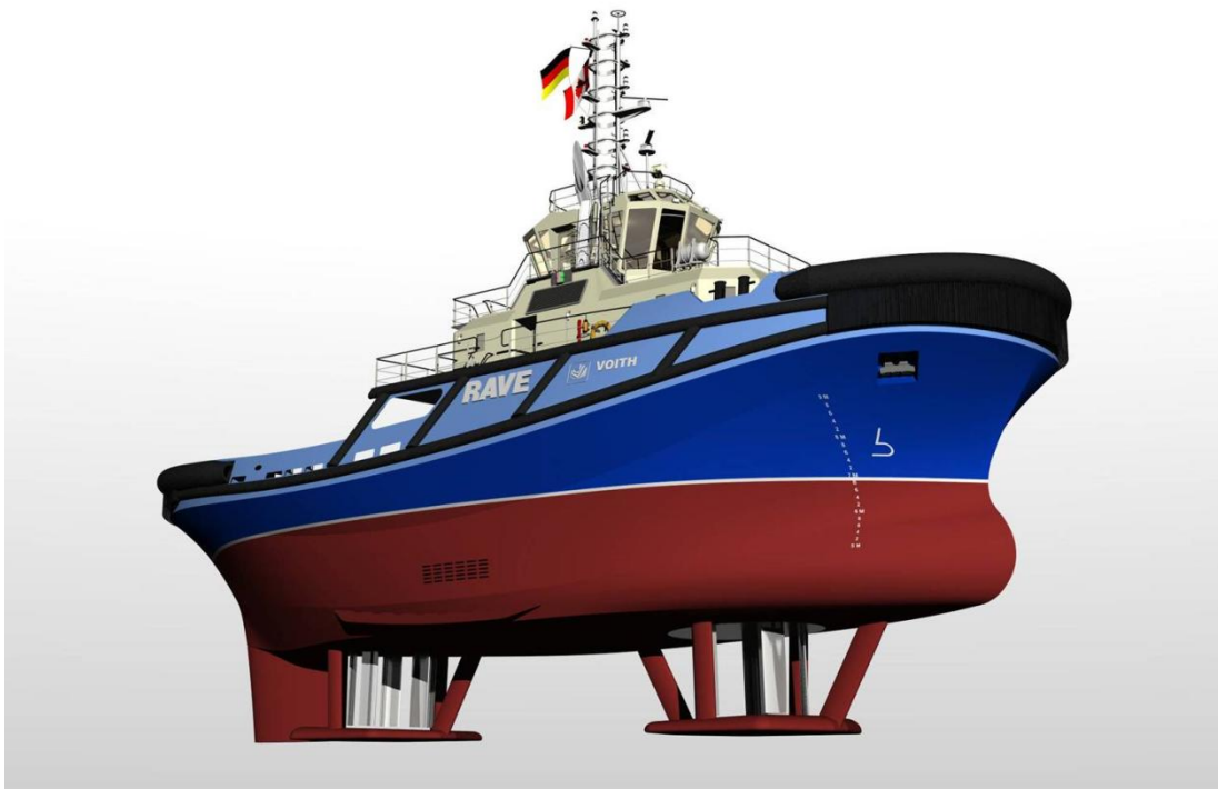
Foto 14: Remolcador con sistema Voith- Schneider (Fuente: http://capitanpinya.com/2012/06/03/nuevo-sistema-de-propulsion-para-remolcadores/ )
