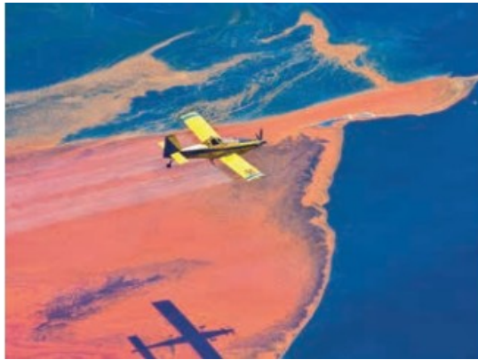
Imágen VI.9 * Air Tractor rociando rociando desde un tagón de rociado bajo el ala sobre un petróleo crudo derramado por una plataforma.
