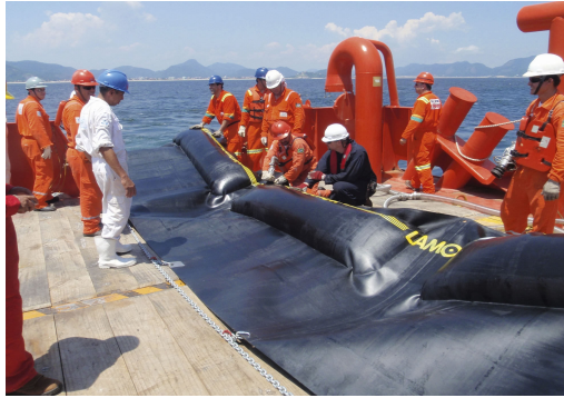
Imágen VI.41 * Barrera de contención hecha de caucho.
