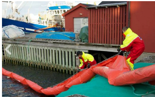
Imágen VI.36 * Barreras con flotador sólido cilíndrico.
