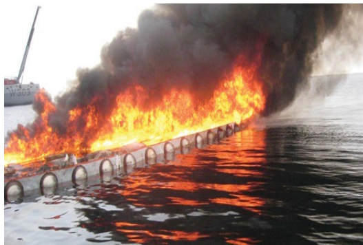
Imágen VI.42 * Barrera resistente al fuego.
