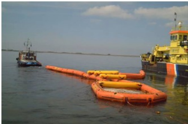
Imágen VI.45 *Barrera recuperadora.
