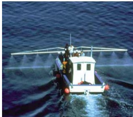
Imágen VI.19 * Adaptación de equipos de rociado a una embarcación de pequeño tamaño.
