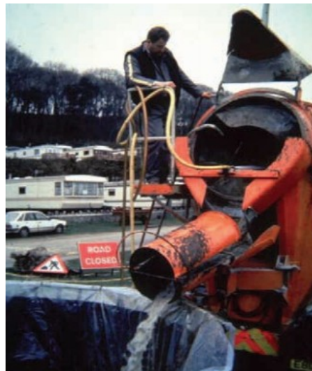
Imágen VI.98 * Limpieza de guijarros y pequeños cantos rodados en un camión hormigonera.
