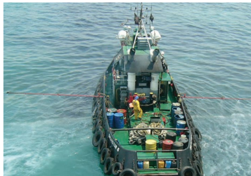
Imágen VI.18 * Remolcador perparado para el rociado de dispersantes .
