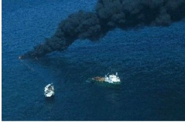
Imágen VI.25 * Incineración in situ de hidrocarburos con barreras remolcadas en configuración "U".
