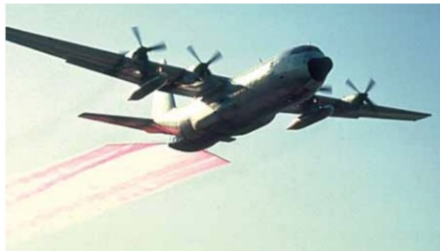
Imágen VI.10 * Aplicación de dispersantes desde aeronaves multimotor.
