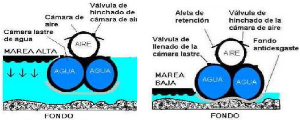
Imágen VI.43 * Función y partes de una barrea de sellado.
