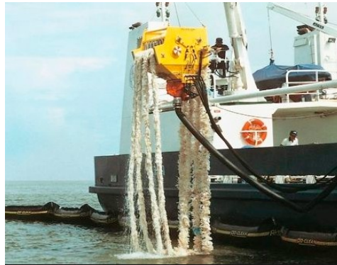
Imágen VI.71 *Skimmer con sistemas de cuerda sin fin sobre una embarcación de recolección.
