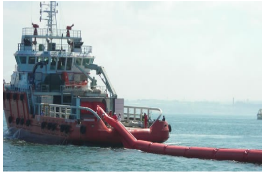
Imágen VI.39 * Barrera auto-inflable desplegada desde una embarcación.
