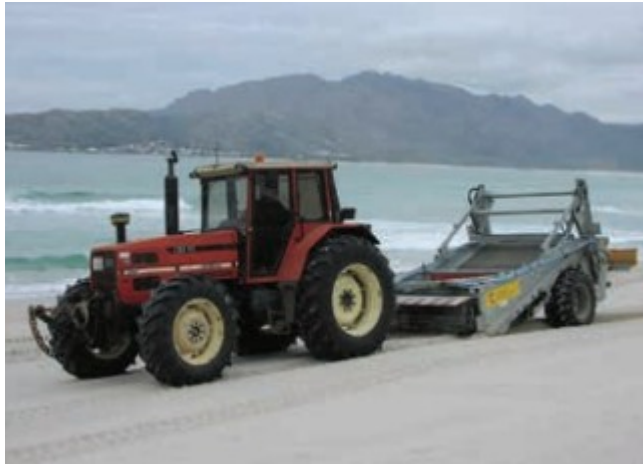
Imágen VI.102 * Recolección de bolas de alquitran mediante un tractor de empuje.
