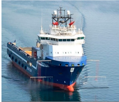
Imágen VI.17 * Buque de gran porte preparado para el rociado de dispersantes.
