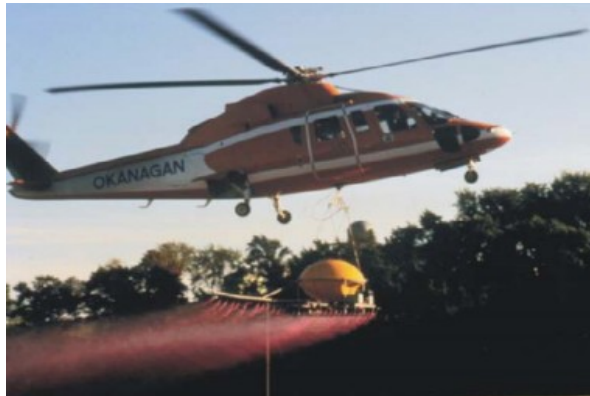
Imágen VI.12 * Helicóptero con sistema de cuba suspendida para el rociado de dispersantes.
