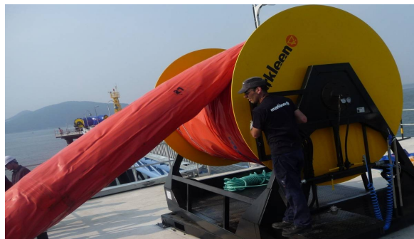
Imágen VI.38 * Barrera con flotador de cámara de aire auto-inflable.
