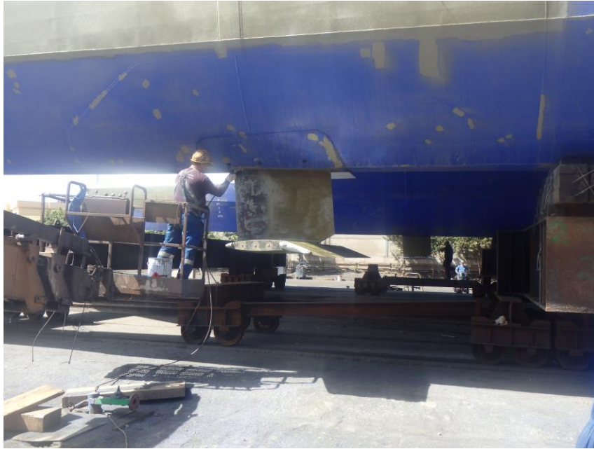
Aplicación de la primera capa de imprimación obra viva
