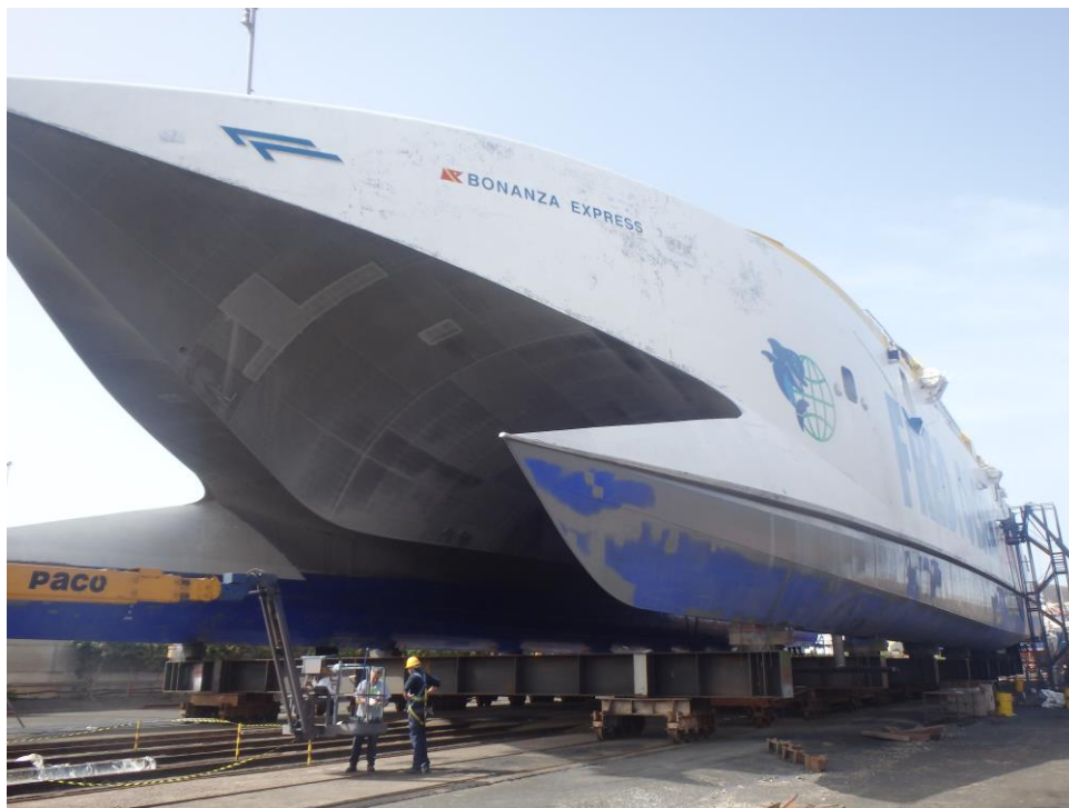
Resultado tras imprimación y lijado obra muerta
