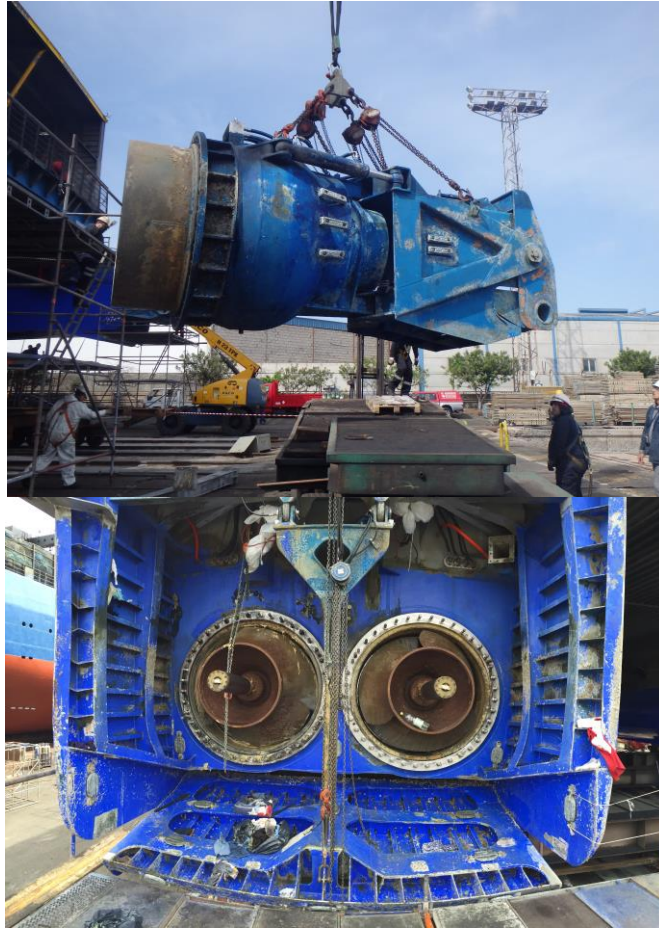
Desmontaje de waterjets de babor
