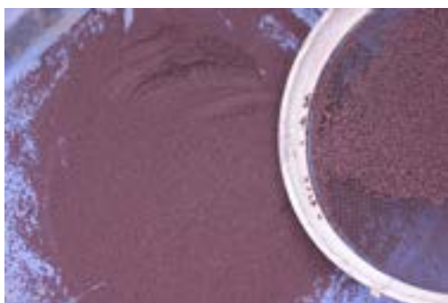
Picón es el árido más utilizado en las mezclas.
