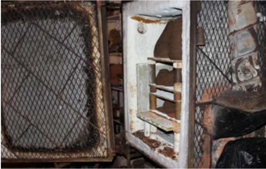
Horno de puerta lateral. Capacidad: 34 x 29 x 59 cm
