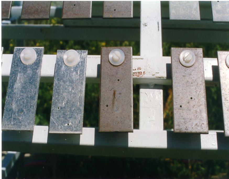
**Figura 4.6:** *Aspecto de unas placas fijadas en una estación.*
