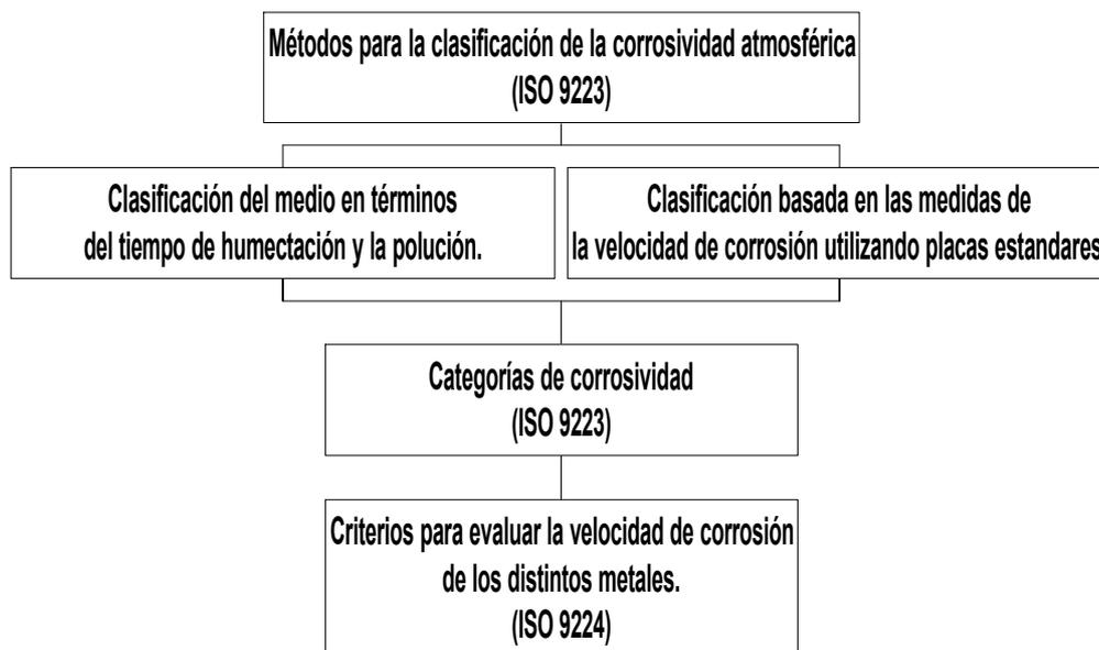
**Figura 5.1:** Clasificación de la corrosividad atmosférica según la norma ISO 9223.
