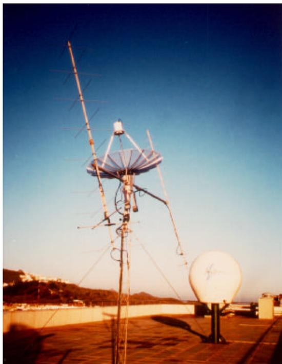
**Figura 3.1.- Sistema de seguimiento y adquisición de imágenes HRPT desarrollado en la Universidad de La Laguna.**
