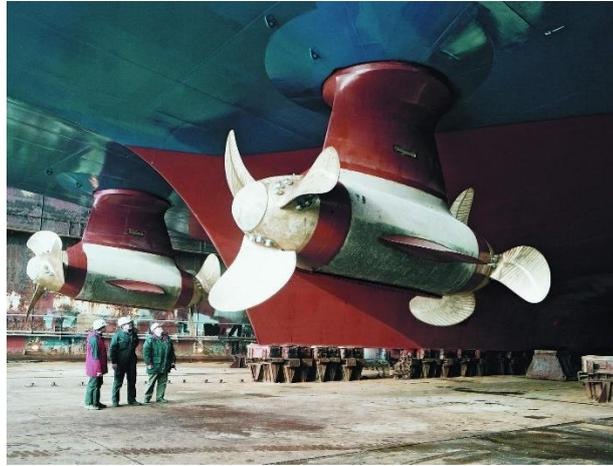
Foto 20: Propulsor Siemens Schottel. Fuente:
