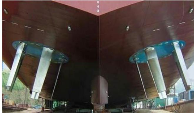
Foto 23: Hélice Voith Schneider (Hélice Cicloidal). Fuente:
