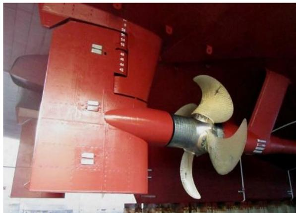
Foto 2: Hélice de paso variable con timón acoplado a popa. Fuente:
