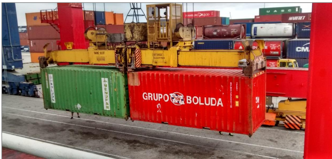
Spreader en modo twin . Fuente: elaboración propia
