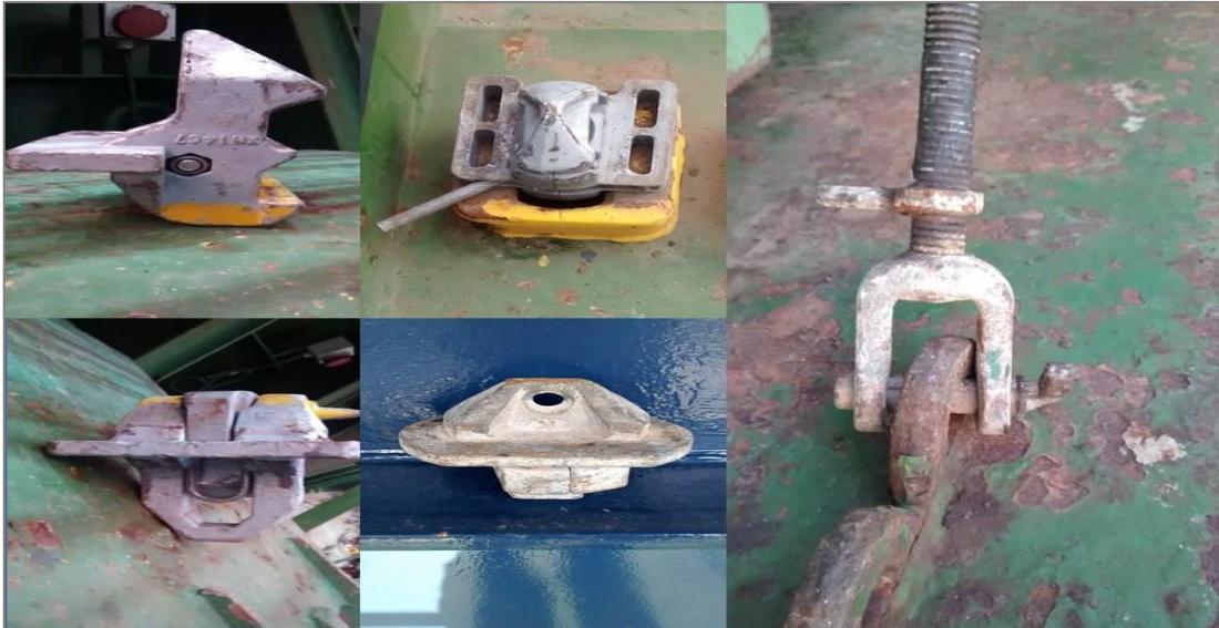
Elementos de trincaje .Fuente: Elaboración propia
