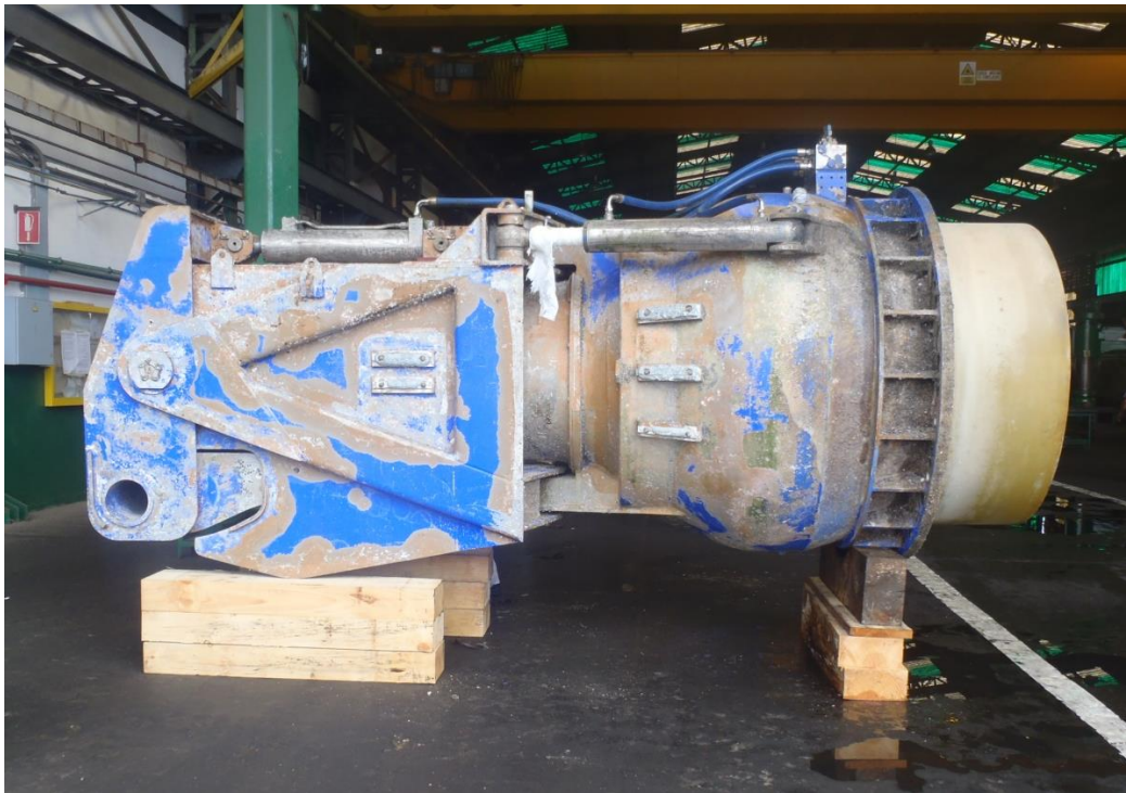
Fig. 31. Waterjet desmontado en astillero
