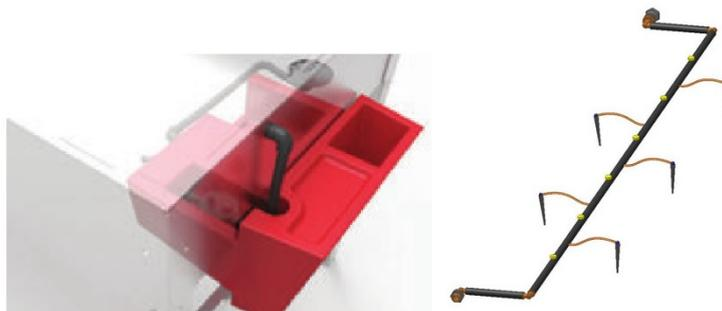
**Figura 2.** Diseño externo del sistema de riego cerrado (izquierda) y diseño de las tuberías de riego/nebulización (derecha) para las mesas de cultivo.
