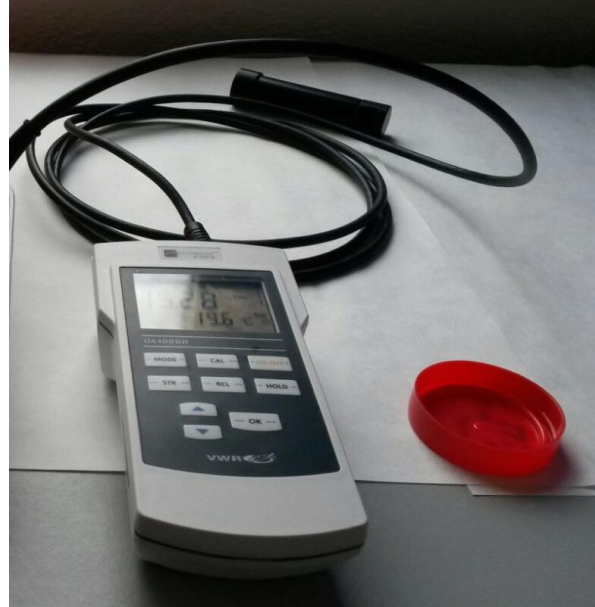
Figura 3.- Medidor de oxígeno disuelto (DO) empleado en la medición del metabolismo de las comunidades.
