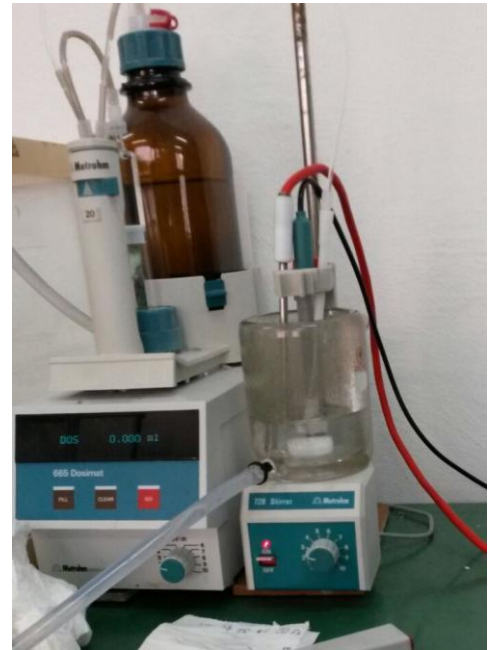
Figura 4.- Titriador modelo Metrohm Dosimat 665® usado en las mediciones de la alcalinidad.
