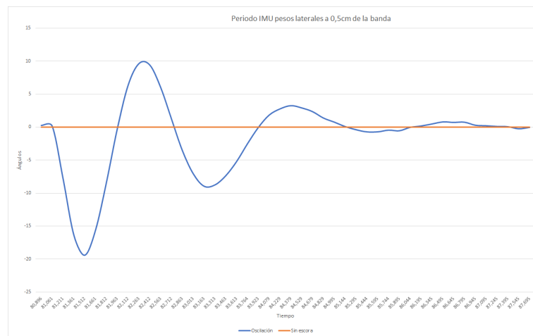
Figura 3.7: Amortiguación del balance para pesos laterales a 0,5 cm de la banda (toma 3).
