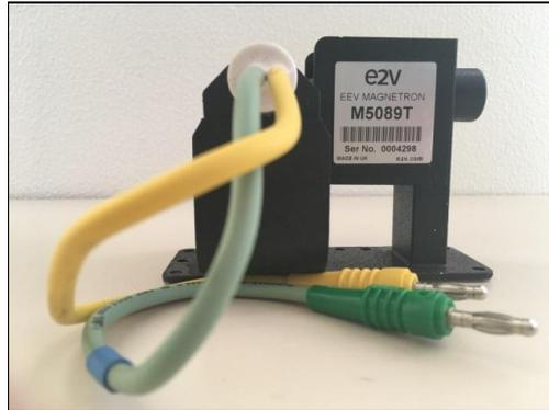
Figura 9. Magnetron 25 Kw – banda X - frecuencia 9.438 GHz. [Fuente: elaboración propia]
