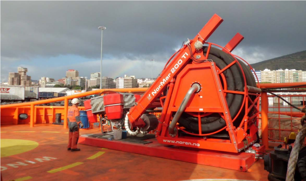
29 Skimmer en la cubierta. Fuente: Trabajo de campo
