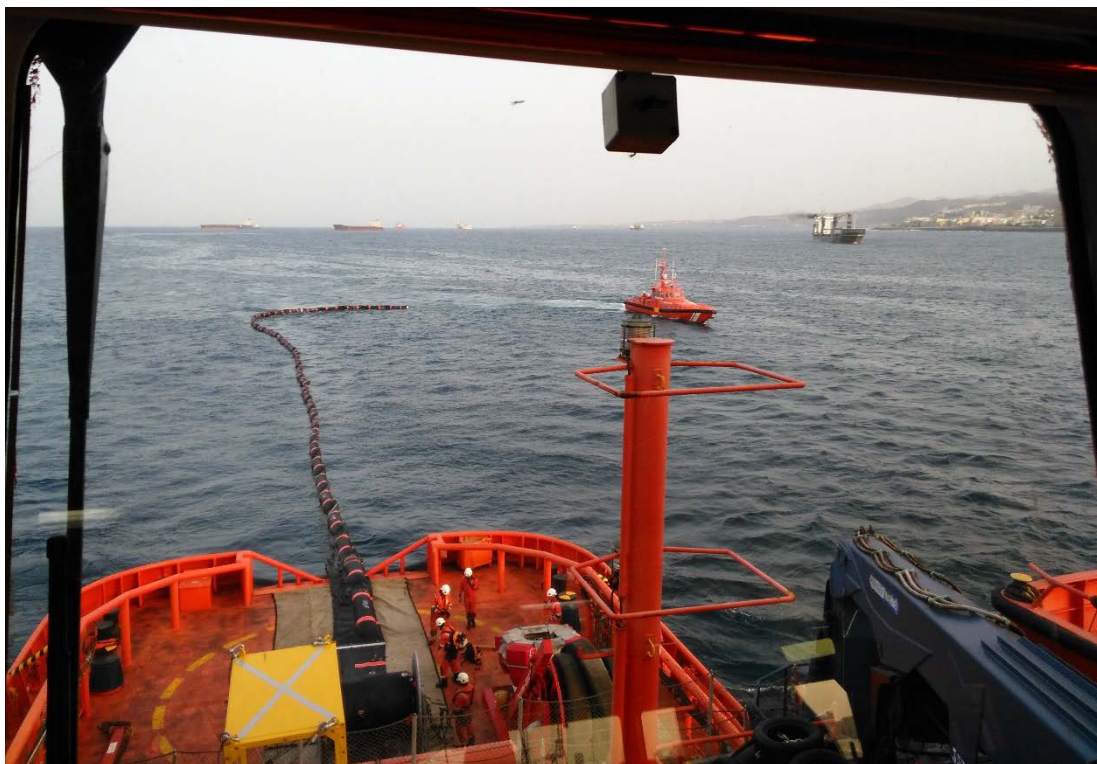
57 Barrera desplegada. Fuente: Trabajo de campo
