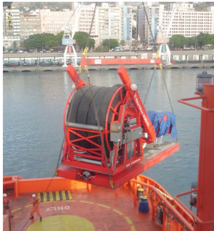
28 Colocación del Skimmer en la cubierta de carga. Fuente: Trabajo de campo
