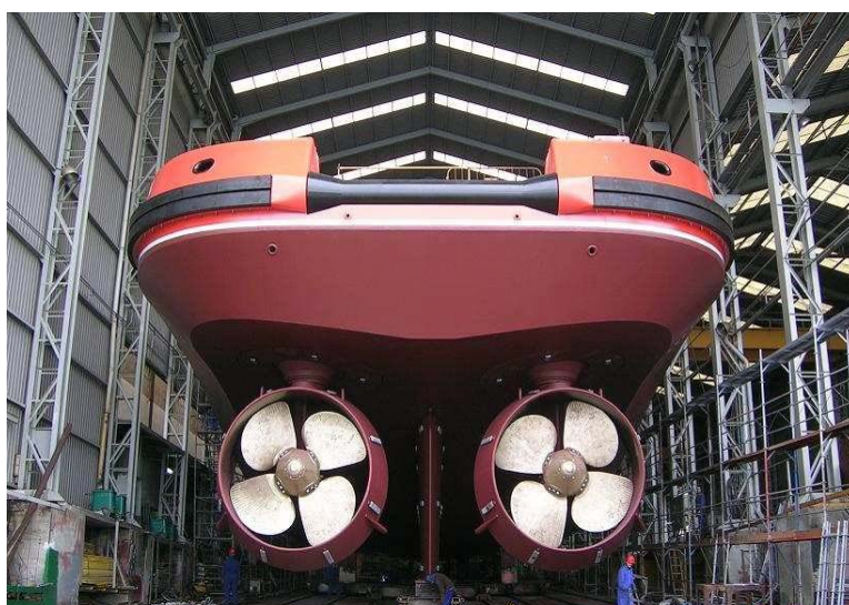
4 Propulsores SCHOTTEL. Fuente: Archivo del buque.
