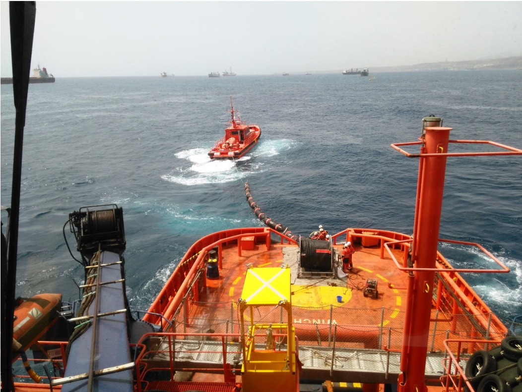
54 Embarcación auxiliar remolcando la barrera. Fuente: Trabajo de campo
