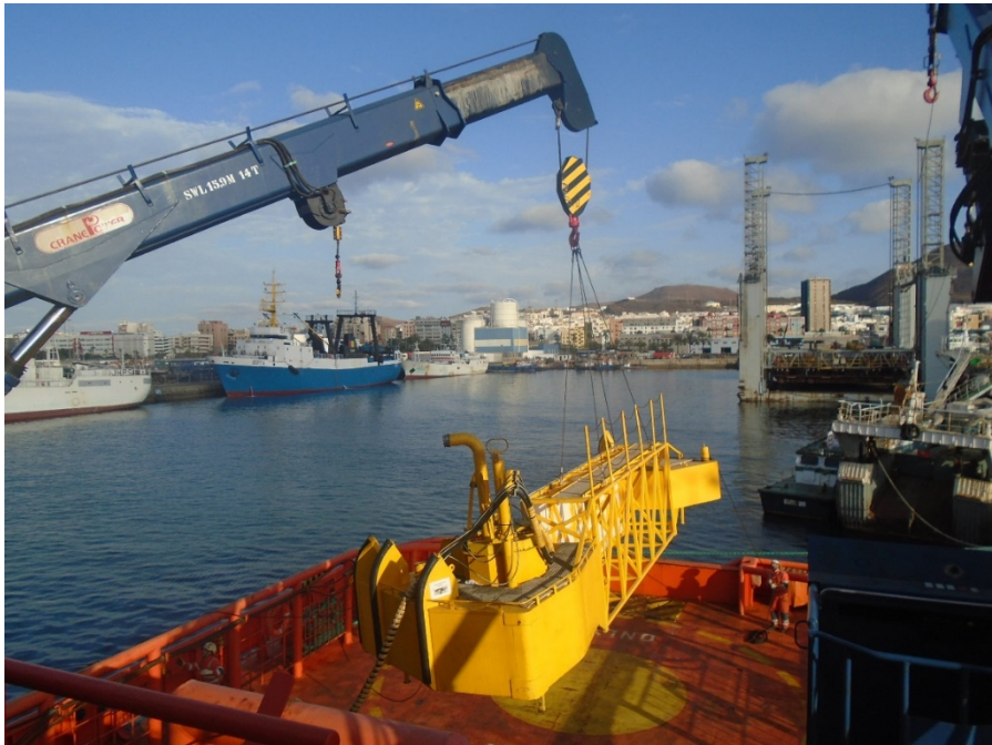
16 Izado del brazo Kamper. Fuente: Trabajo de campo
