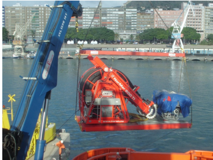
27 Recogida del Skimmer del puerto con las Tugger. Fuente: Trabajo de campo
