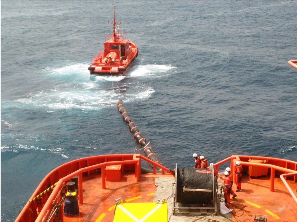
55 Embarcación auxiliar desplegando la barrera. Fuente: Trabajo de campo
