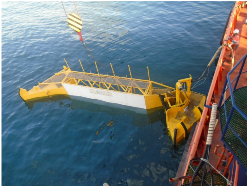
20 Hacer firmes los cabos al buque para que no se suelte el brazo Kamper. Fuente: Trabajo de campo
