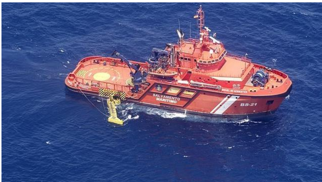
24 Brazo camper en el costado en funcionamiento
