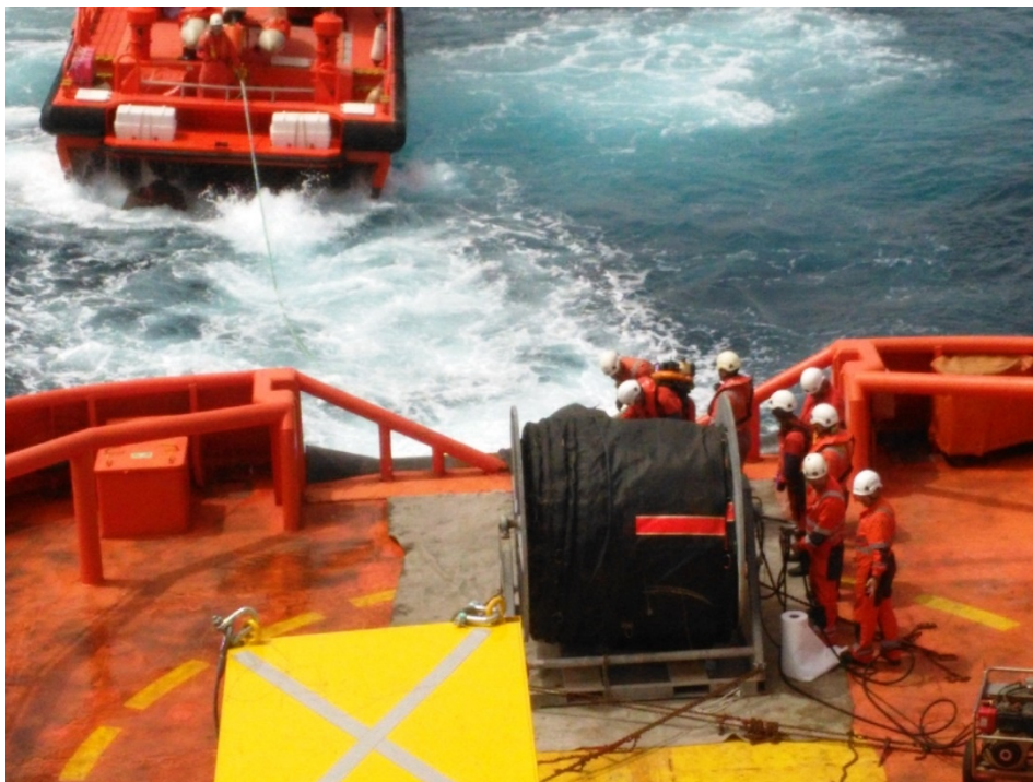
53 Embarcación auxiliar desplegando la barrera. Fuente: Trabajo de campo
