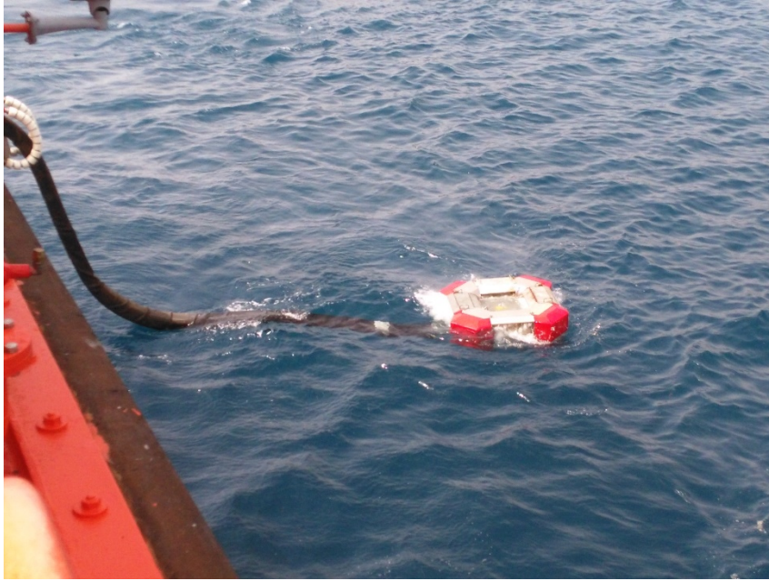
38 Cepillo del Skimmer en funcionamiento. Fuente: Trabajo de campo
