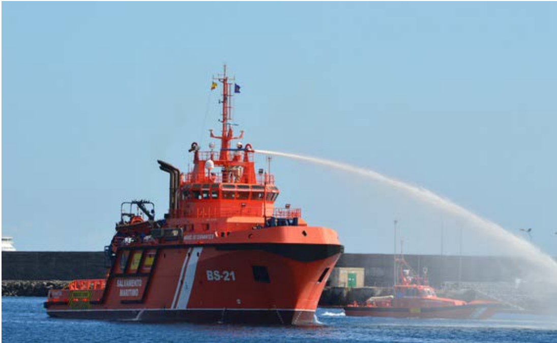
44 Cañón FI-FI de babor en funcionamiento
