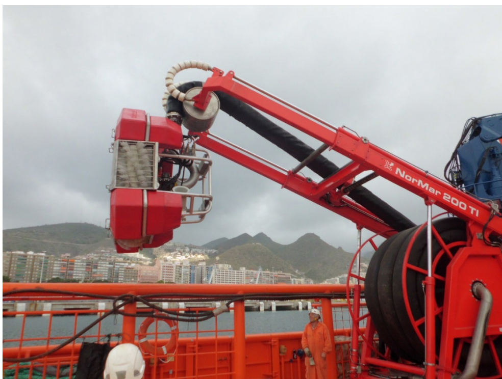
34 Izado del brazo del Skimmer. Fuente: Trabajo de campo
