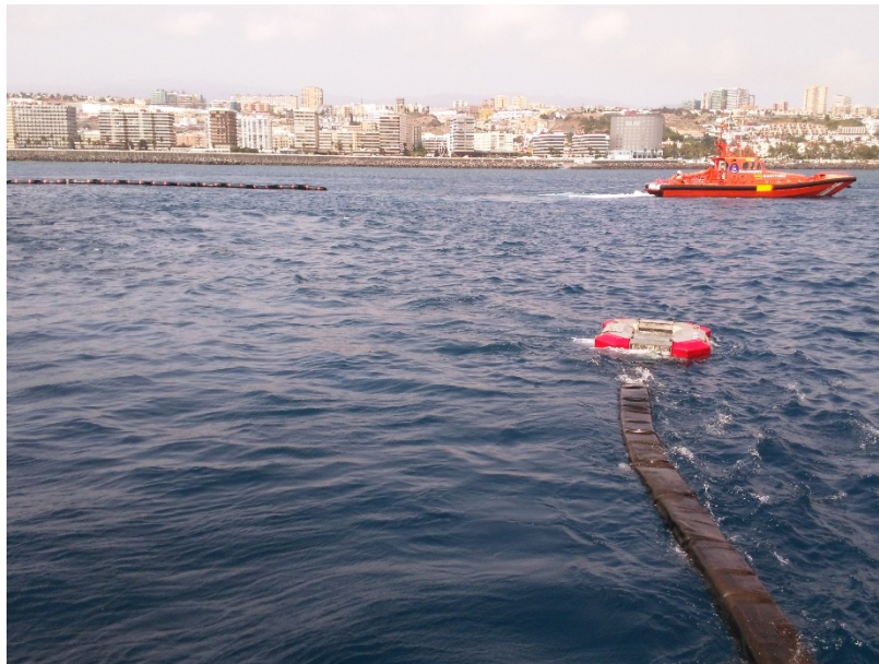
39 Skimmer avanzando mediante los thrusters. Fuente: Trabajo de campo
