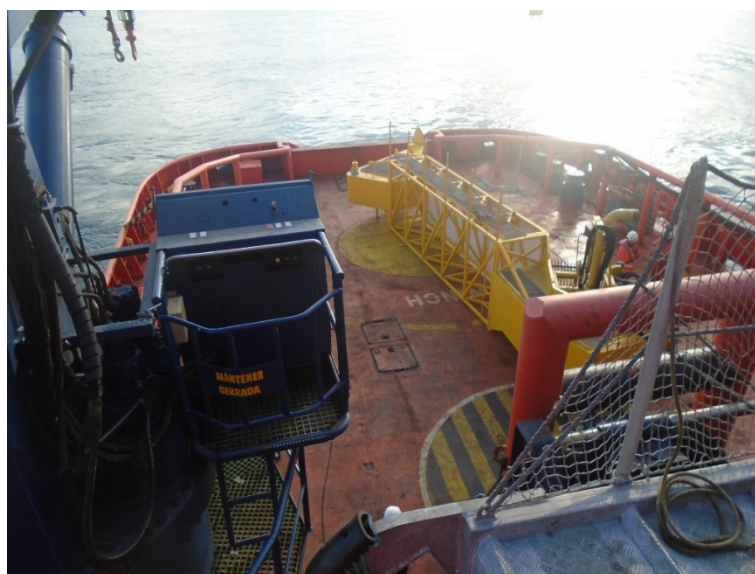
10 Colocación del brazo Kamper en cubierta para el traslado al lugar del vertido. Fuente: Trabajo de campo
