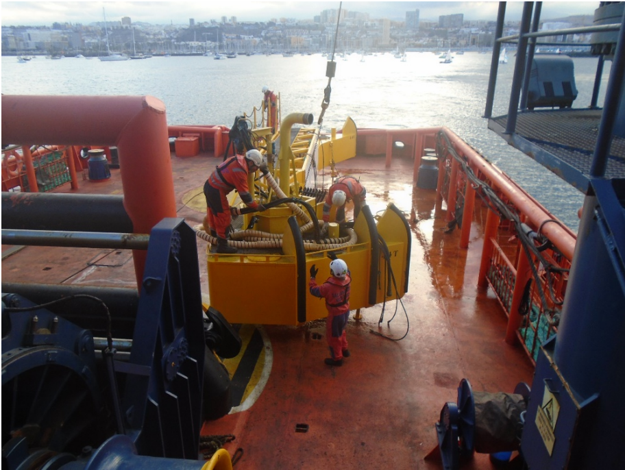
11 Preparación del brazo Kamper. Fuente: Trabajo de campo
