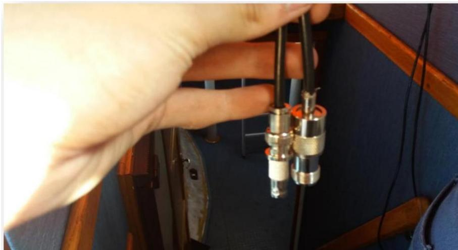
Ilustración 62. Conector BNC. Fuente: Trabajo de campo.
