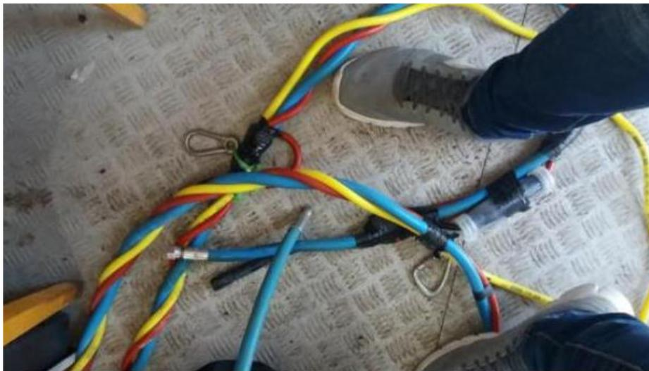
Ilustración 64. Cable umbilical sellado con cinta aislante. Fuente: Trabajo de campo.
