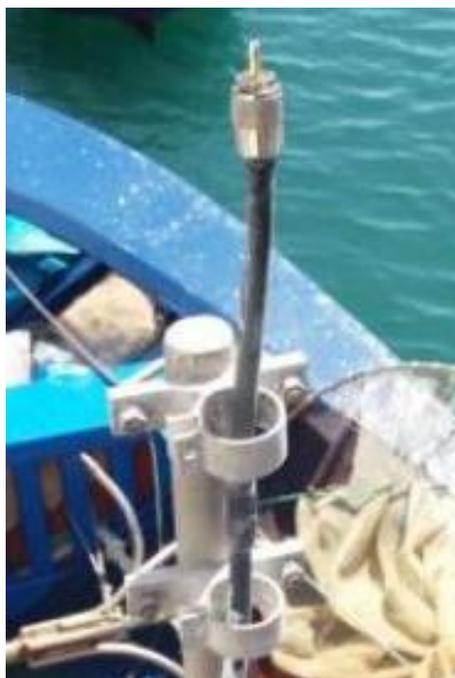
Ilustración 71. Cable de antena del soporte a sustituir. Fuente: Trabajo de campo.
