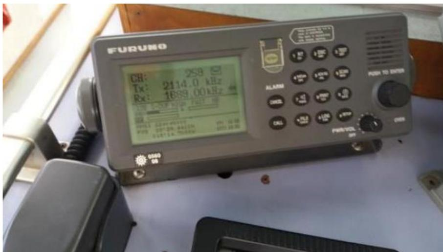
Ilustración 86. Equipo Navtex. Fuente: Trabajo de campo.
