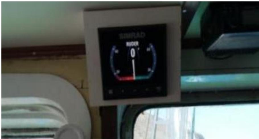
Ilustración 55. Indicador de ángulo en el soporte. Fuente: Trabajo de campo.
