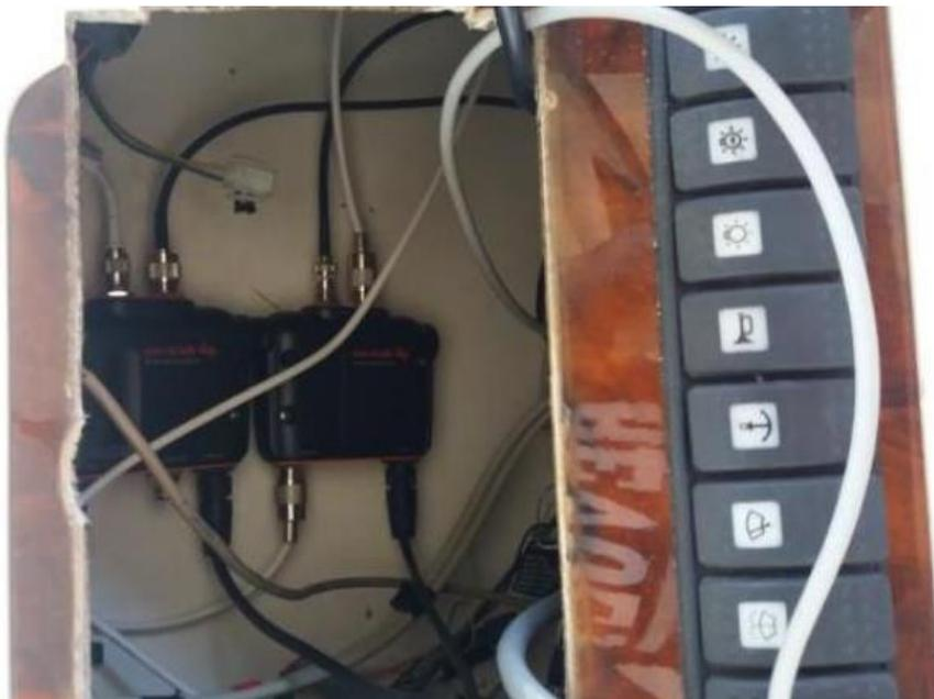
Ilustración 77. Splitter y transductor AIS. Fuente: Trabajo de campo.
