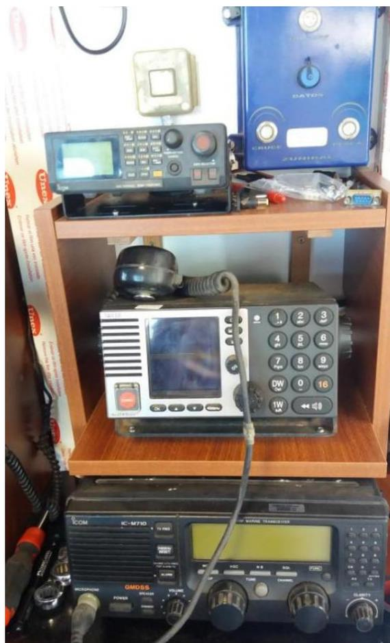
Ilustración 36. Equipo GMDSS onda media y radio VHF. Fuente: Trabajo de campo.
