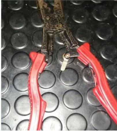
Ilustración 19. Crimpadora. Fuente: Trabajo de campo.
