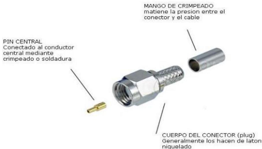
Ilustración 60. Partes del conector. Fuente: <https://www.monografias.com/trabajos105/cable-coaxial/cable-coaxial.shtml>
