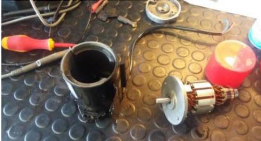
Ilustración 92. Bomba de agua desmontada. Fuente: Trabajo de campo.
