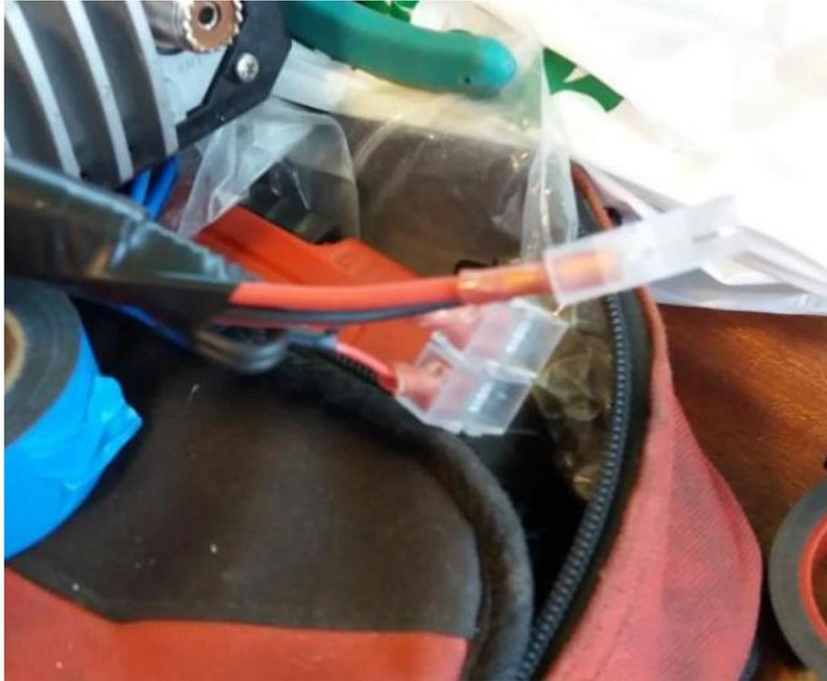
Ilustración 38. Conectores faston recubiertos por regletas. Fuente: Trabajo de campo.
