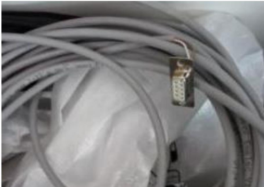
Ilustración 47. Conector DB9 hembra Fuente: Trabajo de campo.
