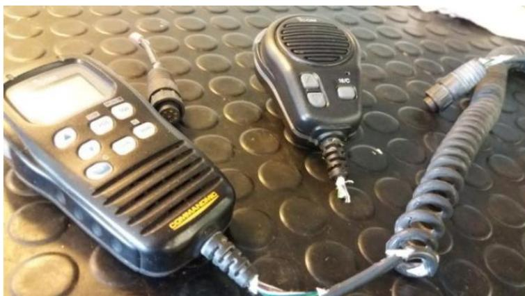
Ilustración 95. Micrófono con cable partido. Fuente: Trabajo de campo.
