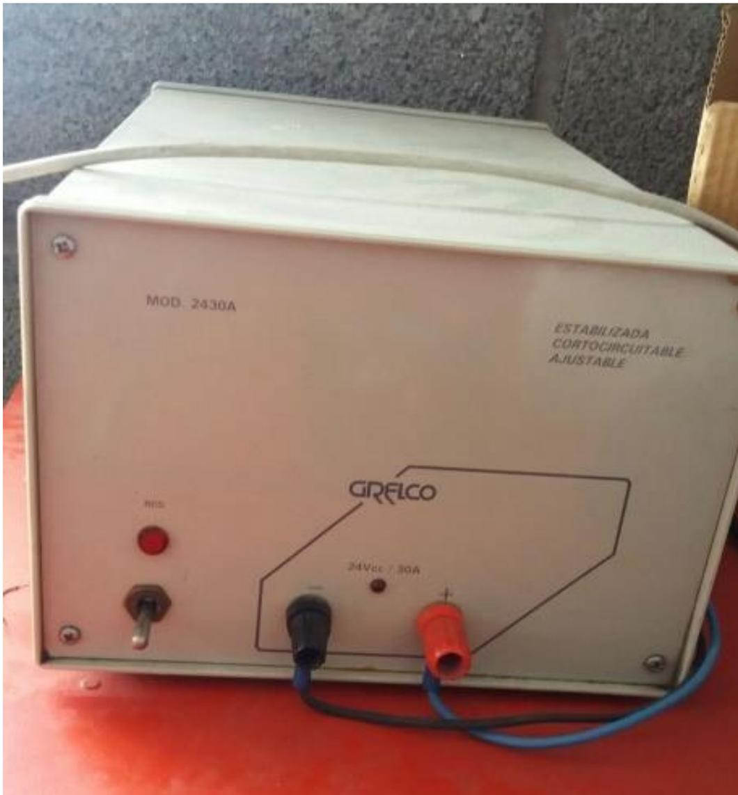
Ilustración 15. Fuente alimentación 24 V. Fuente: Trabajo de campo.
