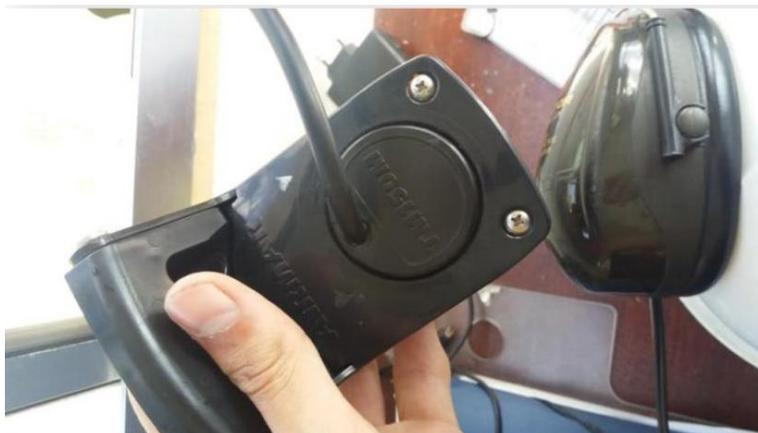
Ilustración 70. Transductor de prueba. Fuente: Trabajo de campo.
