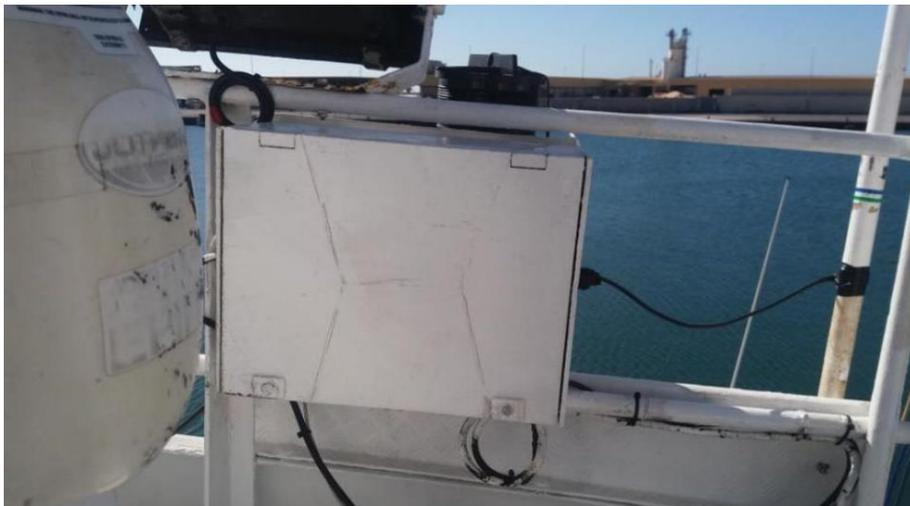
Ilustración 41. Acoplador de antena. Fuente: Trabajo de campo.
