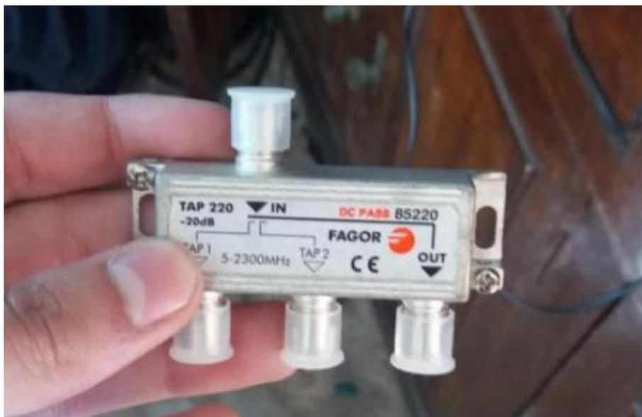
Ilustración 45. Derivador Fuente: Trabajo de campo.
