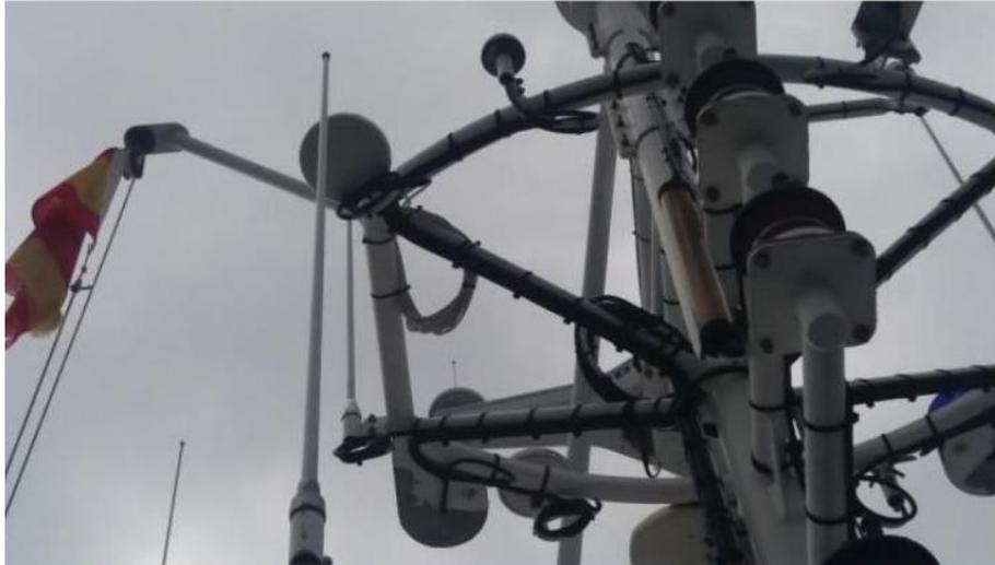
Ilustración 73. Antena con soporte dañado. Fuente: Trabajo de campo.
