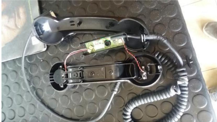
Ilustración 98. Handset desmontado. Fuente: Trabajo de campo.
