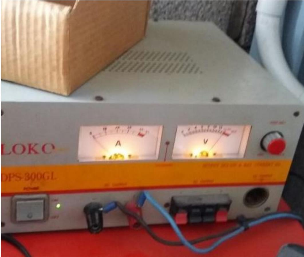
Ilustración 16. Fuente alimentación 12 V. Fuente: Trabajo de campo.
