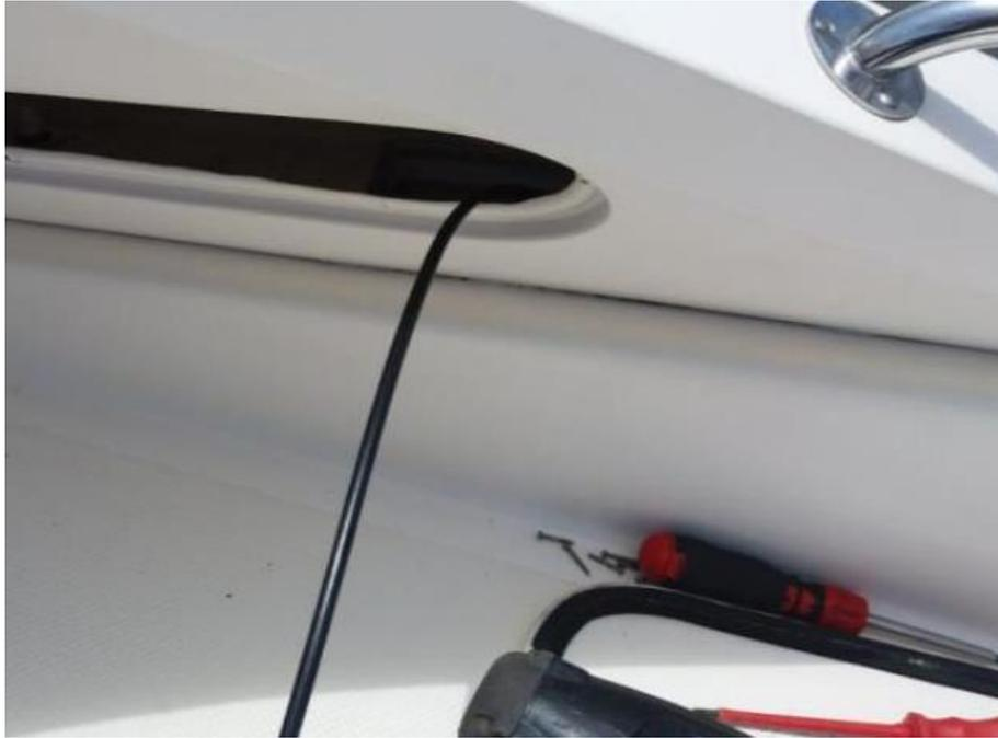
Ilustración 76. Cable de antena VHF en la parte superior del barco. Fuente: Trabajo de campo.
