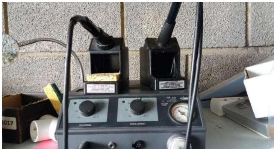
Ilustración 21. Soldador y desoldador. Fuente: Trabajo de campo.
