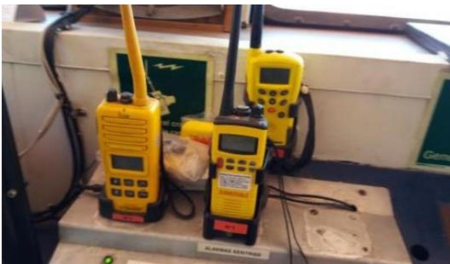
Ilustración 87. VHF portátiles. Fuente: Trabajo de campo.
