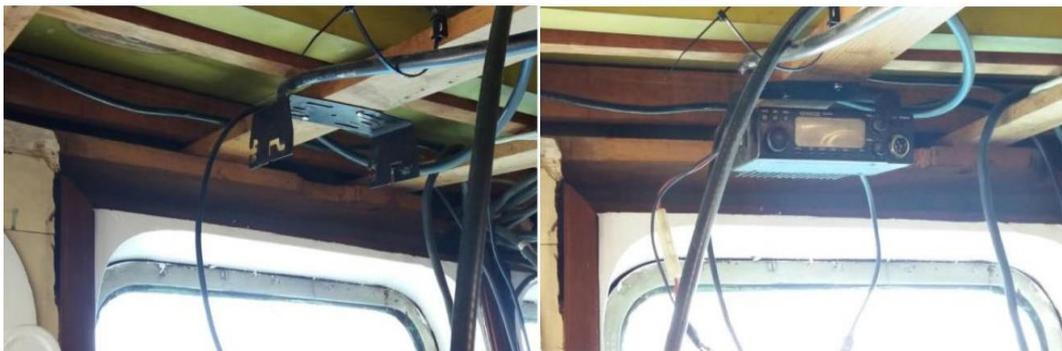
Ilustración 51. Soporte de radio. Fuente: Trabajo de campo.
