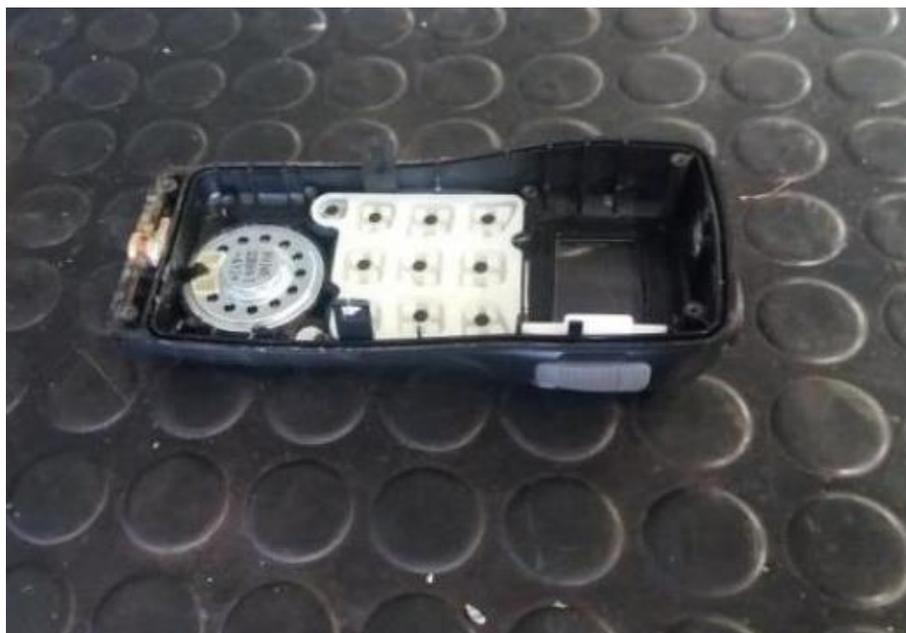
Ilustración 104. Radio portátil con altavoz roto. Fuente: Trabajo de campo.
