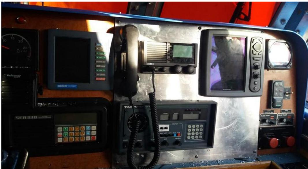
Ilustración 58. Recolocación del onda media, radar y gonio en la nueva chapa.
