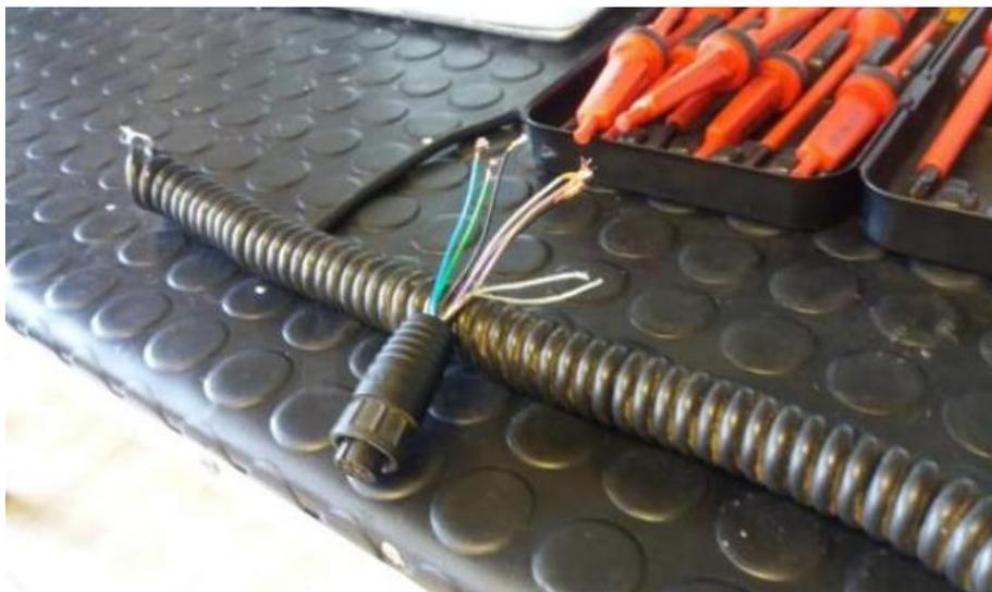
Ilustración 97. Cable de handset quebrado. Fuente: Trabajo de campo.
