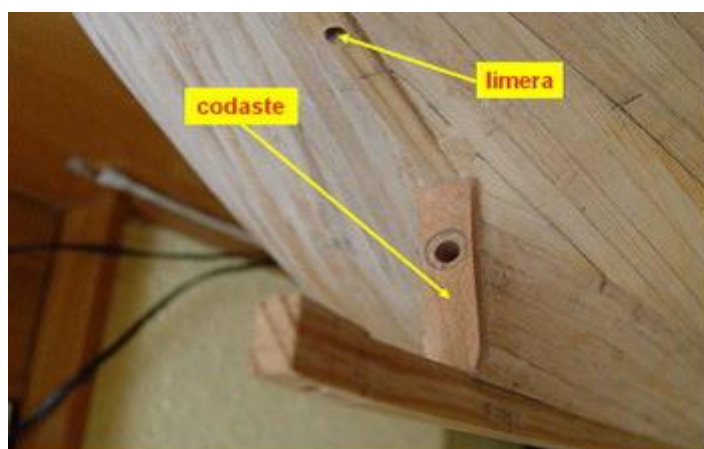
Ilustración 7. Popa en construcción (maqueta). https://ingenieromarino.com/
