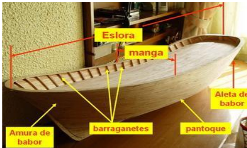
Ilustración 8. Partes de la estructura de un buque (maqueta). https://ingenieromarino.com/
