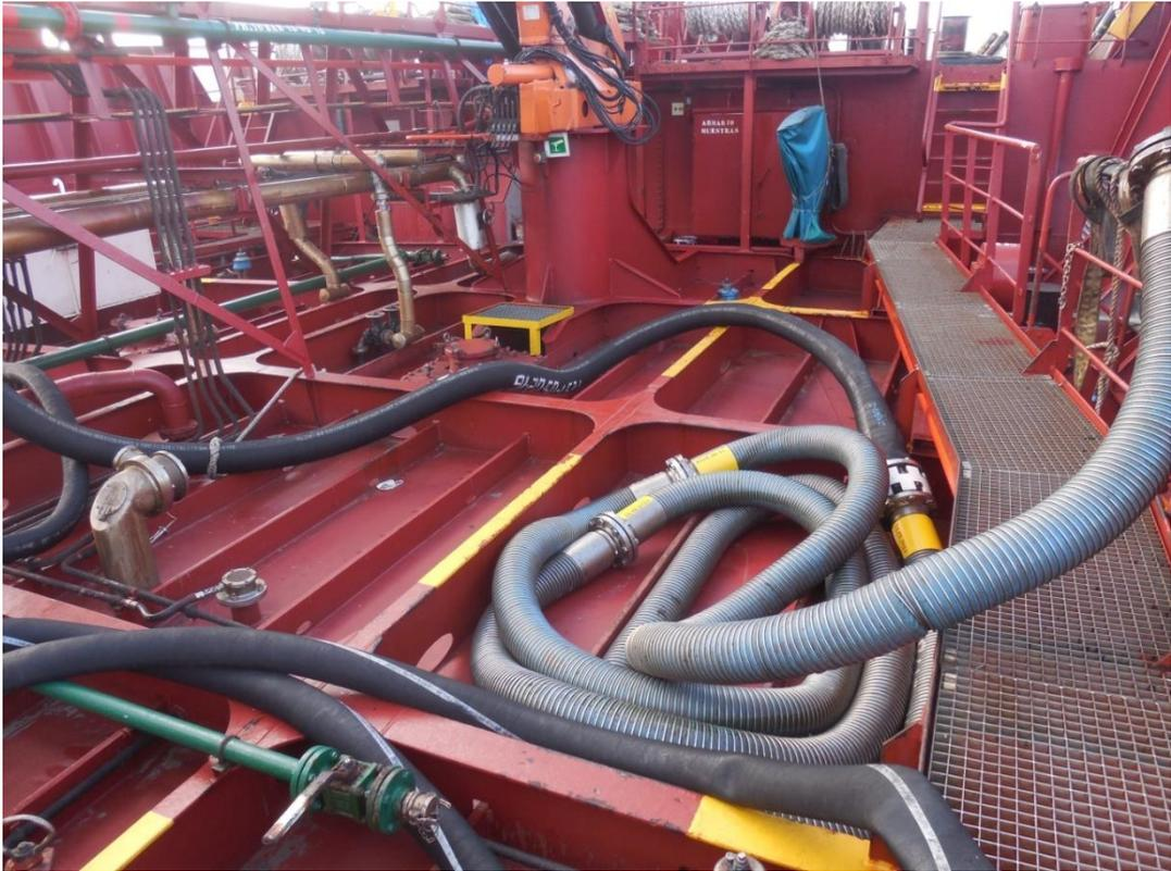
Ilustración 26. B/T Guanarteme. Estiba de mangueras en cubierta. Fuente: Elaboración propia.
