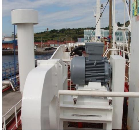
Ilustración 17. Ventilación fija. Fuente: Elaboración propia.
