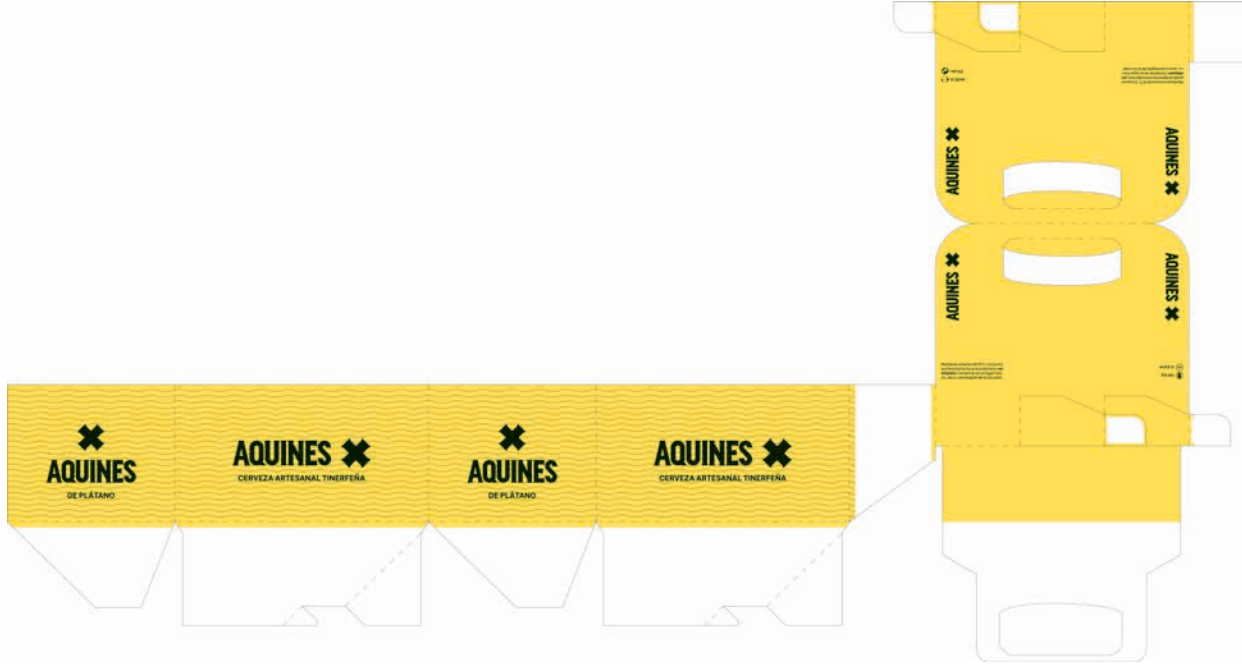
[Figura 43, 44, 45 y 46] Diseños aplicados a plano de los envases secundarios de productos embotellados siguiendo las tres versiones de cerveza elaboradas por la empresa, y reproducción 3D de envase secundario para los productos embotellados Aquines de kiwi
