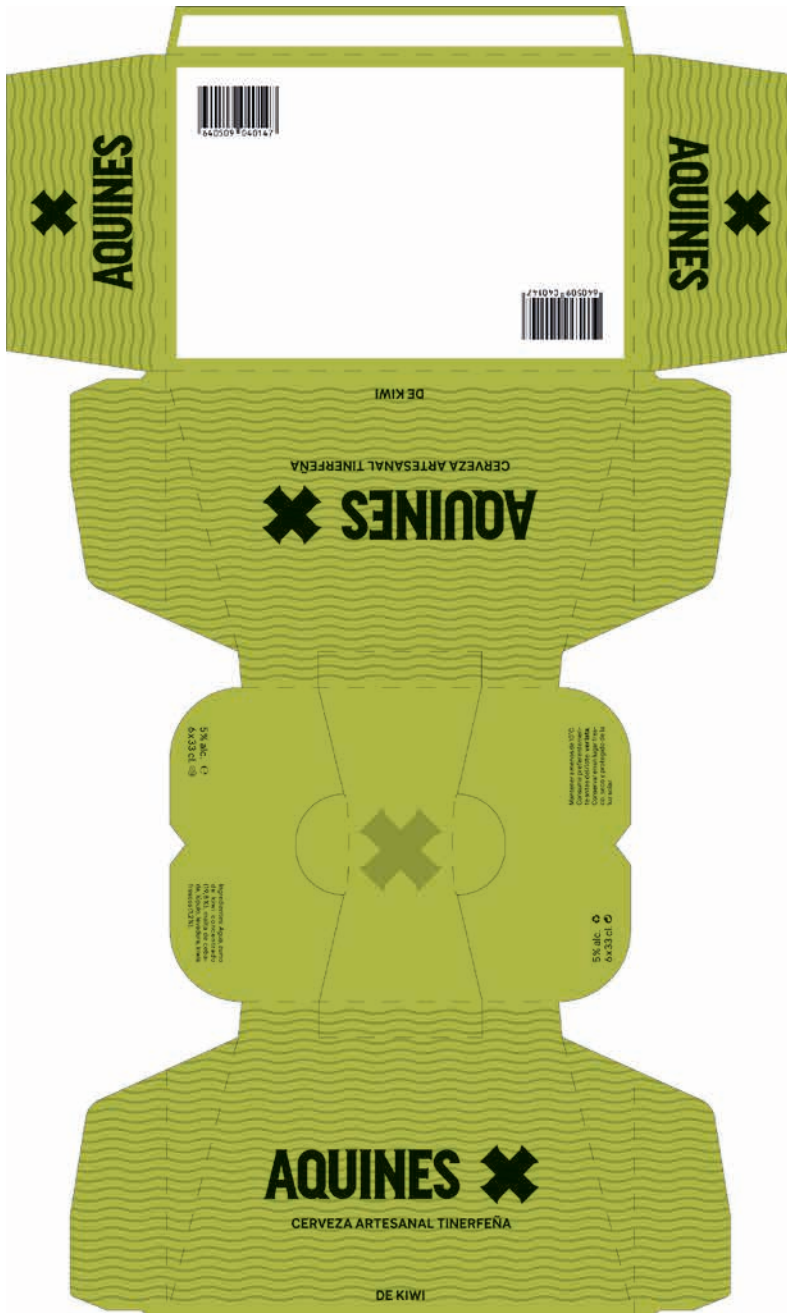
[Figura 50] Diseño aplicado a plano de la primera preferencia de envase secundario de productos enlatados siguiendo el estilo del producto Aquines de kiwi Fuente: Trabajo propio.
