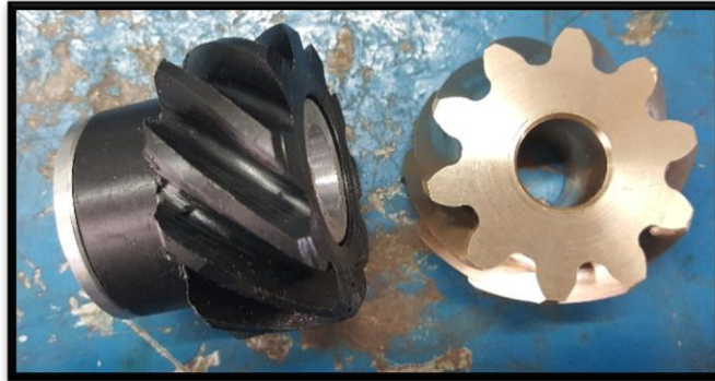
Ilustración N° 58. Engranaje helicoidal de diez dientes. Réplica en bronce.
