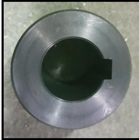
Ilustración N° 76. Finalización del chavetero interior.
