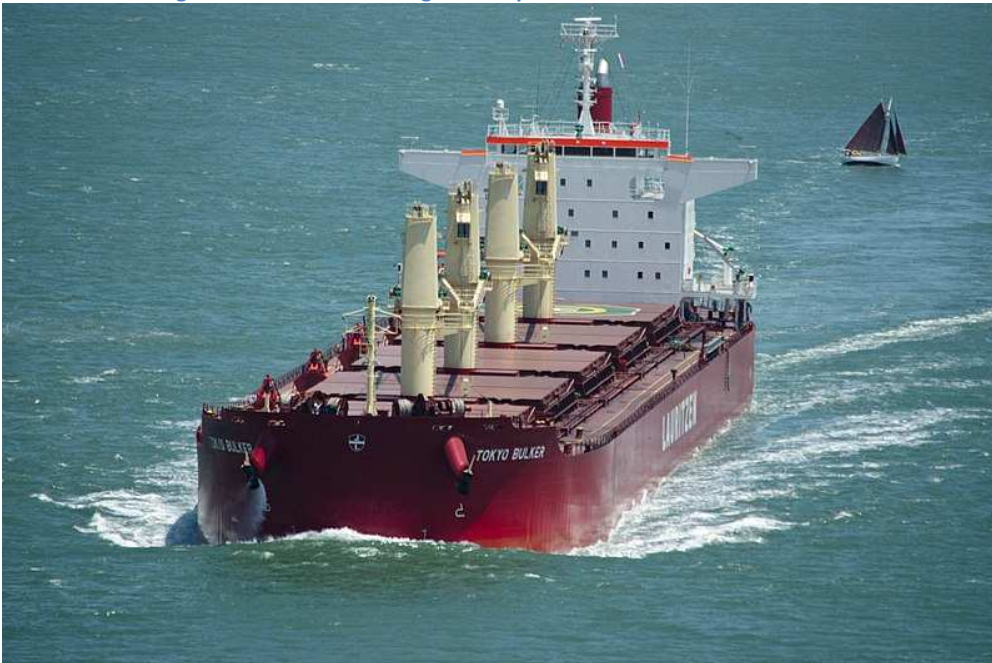
Figura 4 Acumulación de agua en la proa al avance de un bulk carrier
