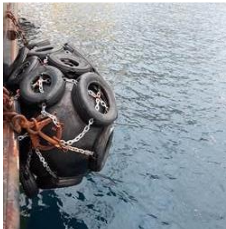
Ilustración 5. Defensa del costado de estribor. Fuente: elaboración propia.
