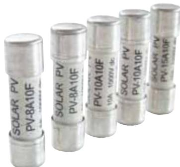
Una gama de fusibles 10x38mm especialmente diseñados para la protección y asilamiento de cadenas fotovoltaicas. Los fusibles puede interrumpir las pequeñas sobrecargas asociadas a circuitos FV defectuosos. De esta forma la protección actuará a partir de  $1,3 \times I_n$  asegurando una óptima protección de la instalación.
