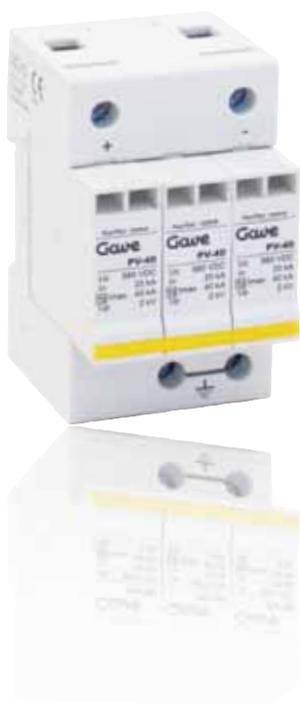
Las protecciones de Clase II se destinan a la protección de las redes de alimentación fotovoltaica contra las sobretensiones transitorias debidas a descargas atmosféricas. Los productos se instalan en paralelo en las redes a proteger y ofrecen una protección en modo común o modo común y diferencial. El esquema eléctrico integra varistores con un sistema de desconexión y sus indicadores asociados.
