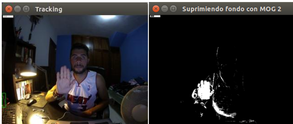
Figura 3.6: Supresión de fondo con MOG2 aplicando erode()
