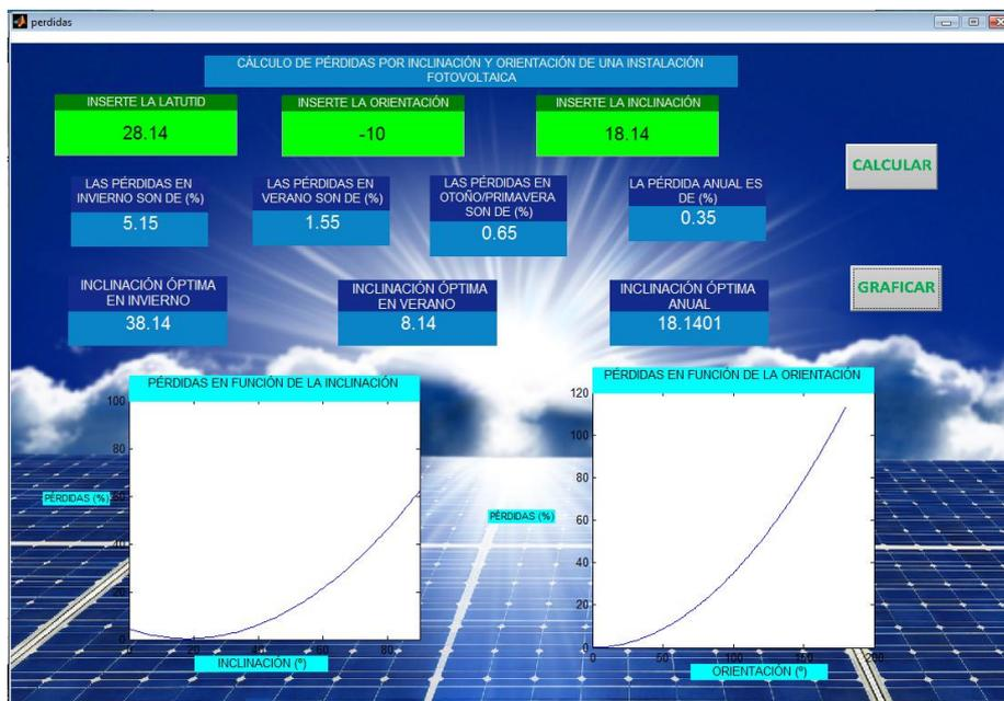
Figura 17. Pérdidas por orientación e inclinación de la vivienda de estudio con los módulos en inclinación óptima.
