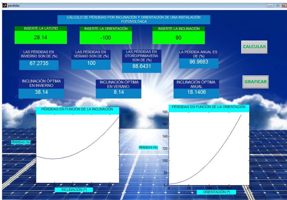
Figura 14. Pérdidas por orientación e inclinación de la fachada principal.
