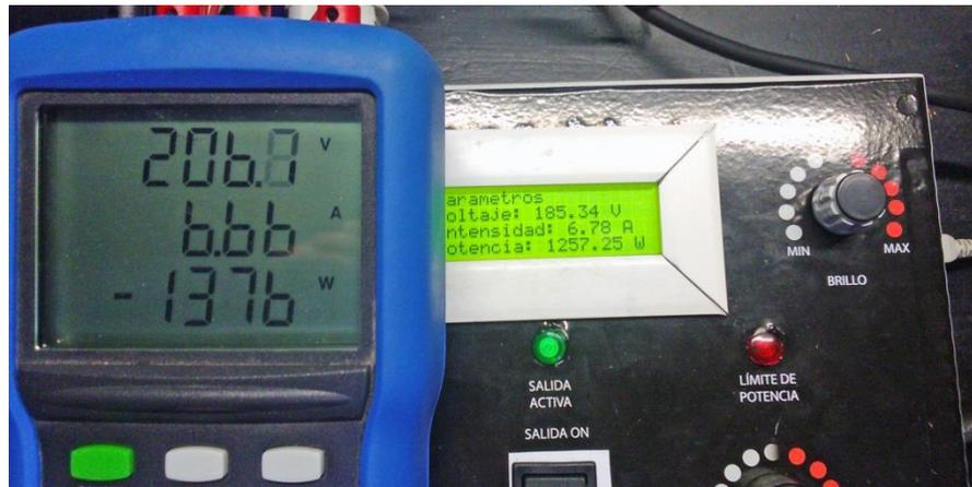
Figura VI.9. Resultado Experimental Comparación Potencia Meteix PX120
