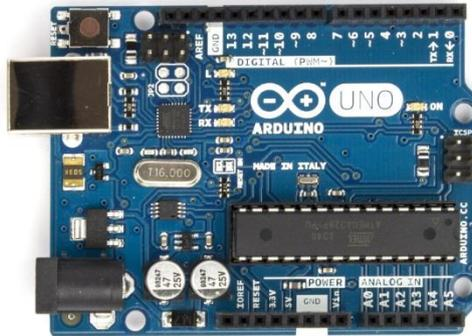
*Figura III.8. Placa de Desarrollo Arduino Uno Rev. 3*
