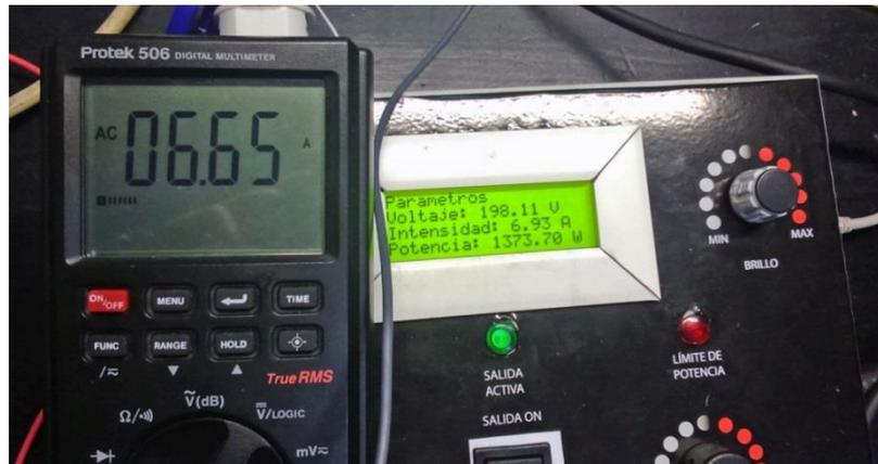
Figura VI.5. Resultado Experimental Comparación Intensidad True RMS
