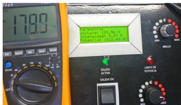
Figura VI.2. Resultado Experimental Comparación con Voltaje NO True RMS
