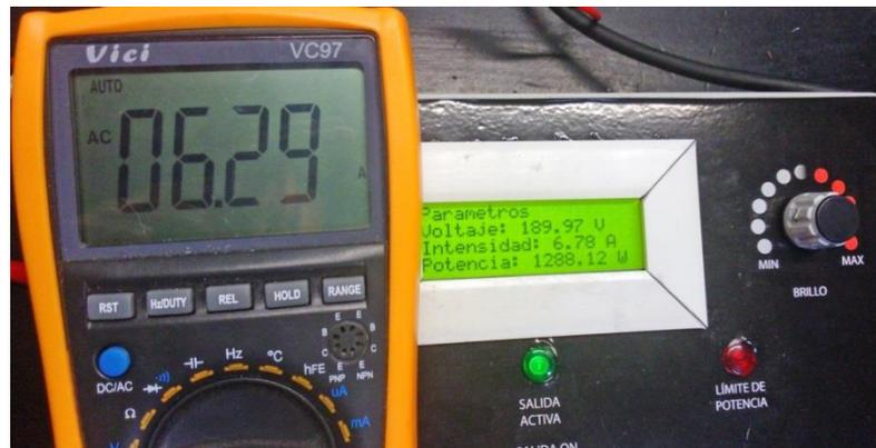
Figura VI.6. Resultado Experimental Comparación Intensidad NO True RMS
