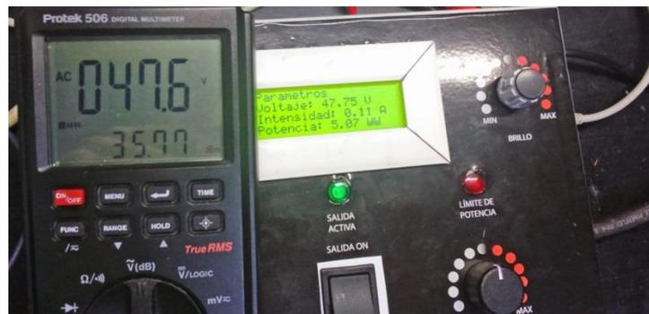
Figura VI.1. Resultado Experimental Comparación con Voltaje True RMS
