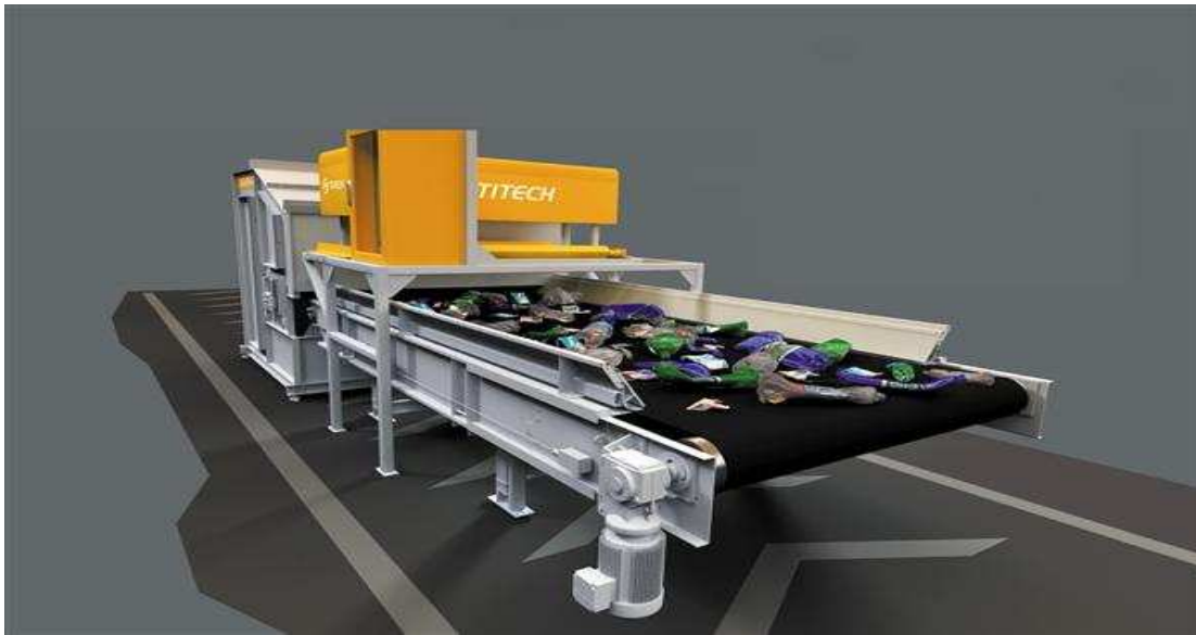
Figura 25. Máquina separadora de plásticos Titech Autosort. Fuente: Titech.
