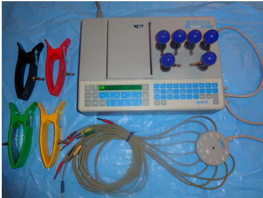
Figura 1.6: Electrocardiógrafo típico con sensores tipo pinza y tipo ventosa.
