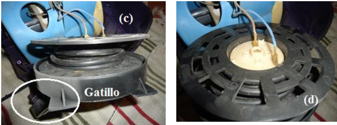
Figura 1.17: Aspiradora con mecanismo de trinquete; (a) Aspiradora comercial, (b) Ubicación del sistema de recogecables, (c) Dispositivo de recogida de cables con detalle del gatillo, (d) Conexión eléctrica.
