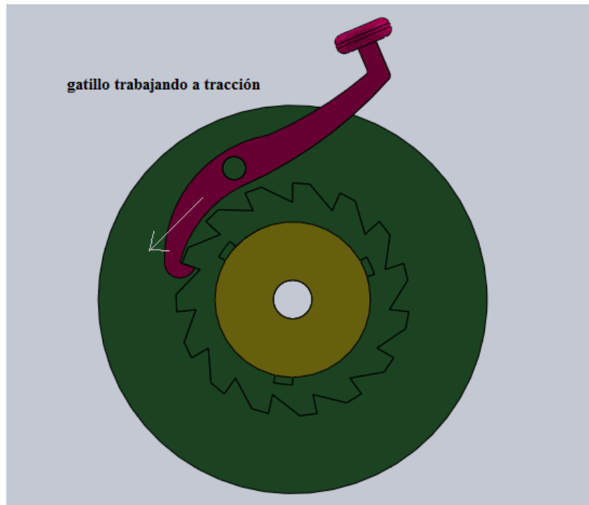
Figura 2.4: Funcionamiento del gatillo del prototipo 2, trabajando a tracción.
