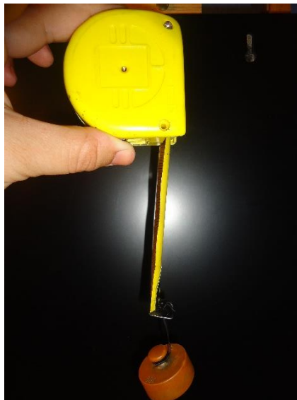
Figura 2.16: Ensayo de las fuerzas del resorte de tensión constante.
