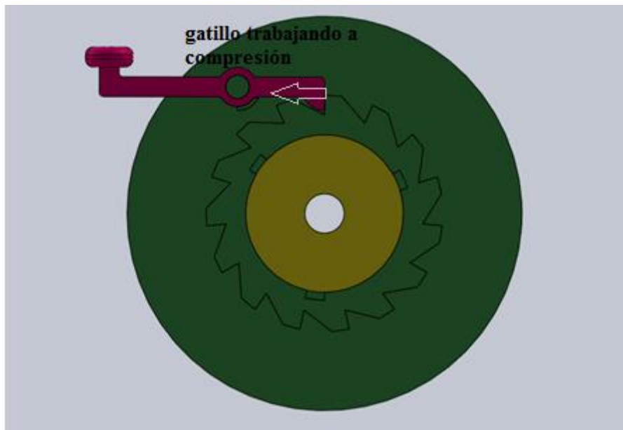
Figura 2.3: Funcionamiento de la primera versión del gatillo, trabajando a compresión.
