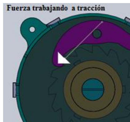
Figura 2.5: Funcionamiento del gatillo en el prototipo 3, trabajando a tracción.
