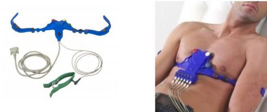
Figura 1.10: Sistema de armazón para los sensores del electrocardiógrafo. A la izquierda detalle del sistema y a la derecha sobre el paciente.
